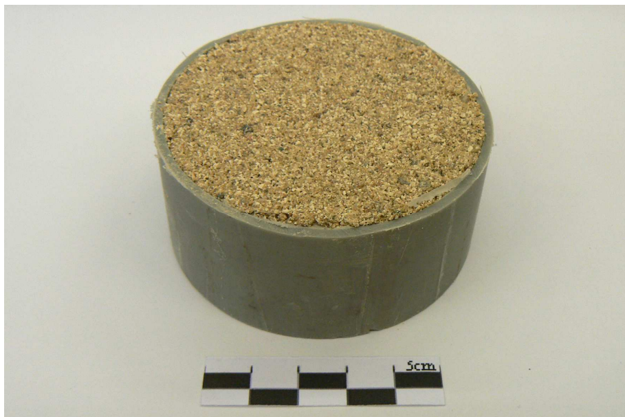
Fotografie 1: Vzorek imitující korodovanou vápennou omítku
