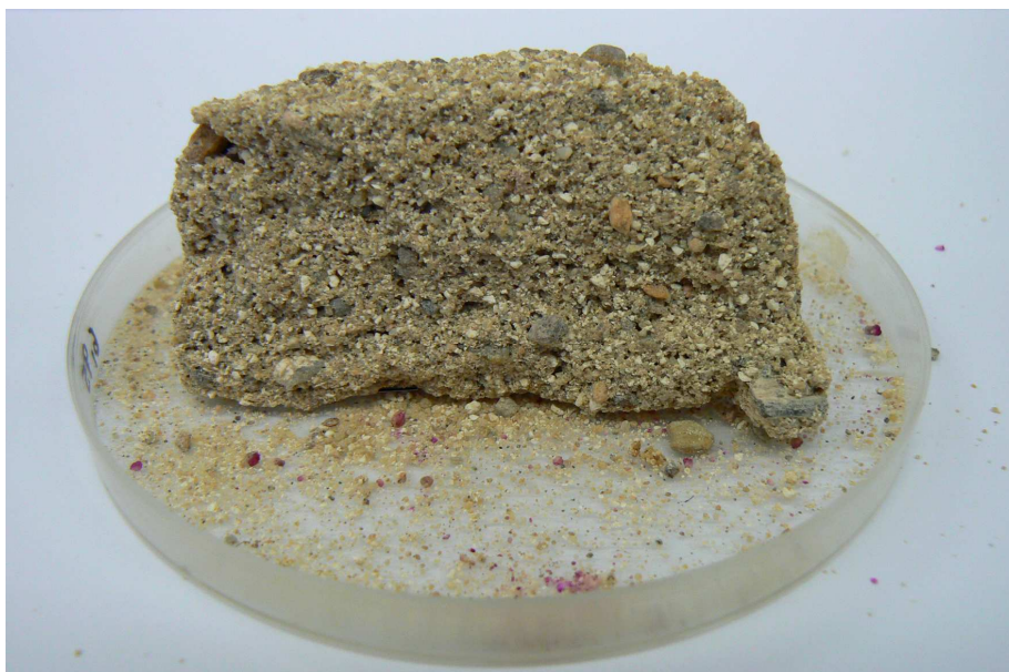
Fotografie 2: Vnitřní struktura vzorku imitujícího korodovanou vápennou omítku
