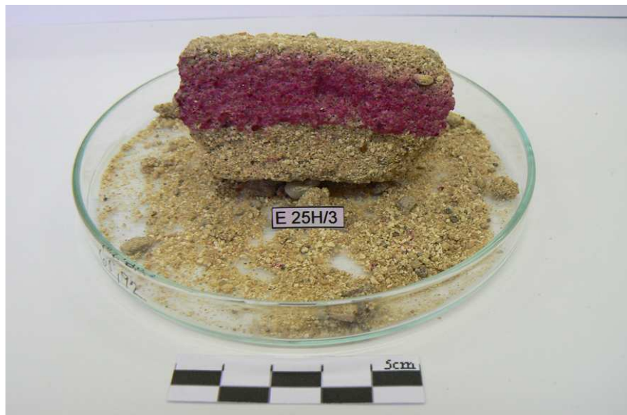
Fotografie 7: Vzorek imitující korodovanou omítku po aplikaci konsolidantu metodou nátěru a vybarvení hloubky penetrace pomocí fenolftaleinového indikátoru.
