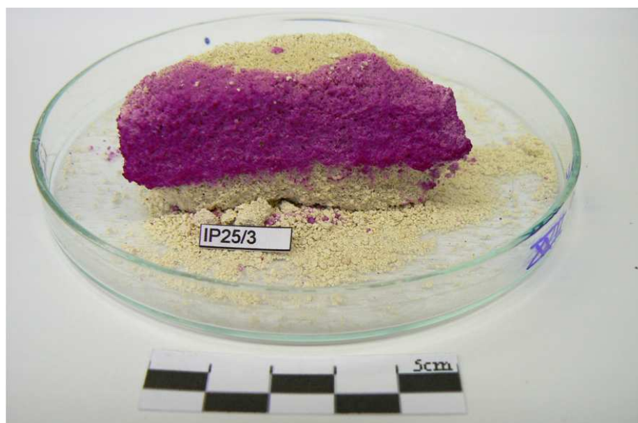
Fotografie 8: Vzorek imitující korodovaný vápenec po aplikaci konsolidantu metodou vzlínání a vybarvení hloubky penetrace pomocí fenolftaleinového indikátoru.
