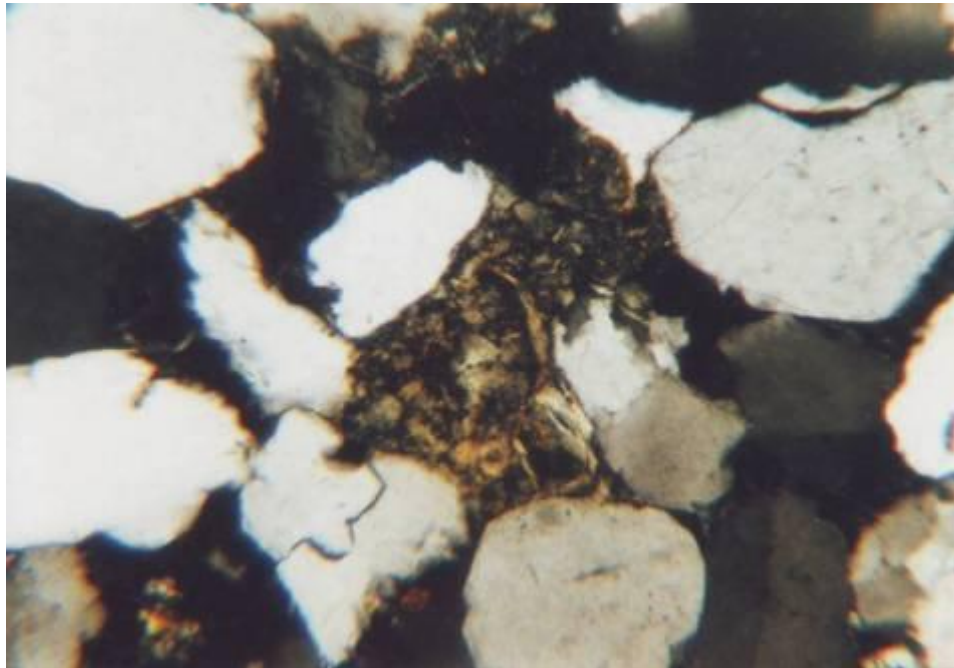
Pískovec křemenný středně zrnitý, silicifikovaný s glaukonitem LU-2, zvětšení 63x, nikoly X lokální nahromadění základní hmoty – matrix (křemen, slída, kaolinit?)
