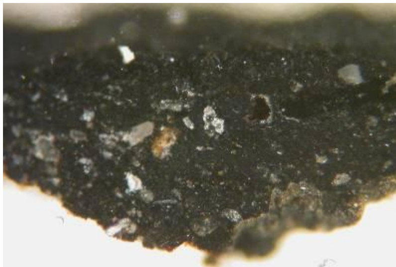
Vzorek č. 3 – draperie, černá – černou vrstvu tvoří částice uhlové černi s příměsí pravděpodobně zinkové běloby v olejovém pojivu (žlutozelená fluorescence v UV světle - úlomek vrstvy je lehce napadán působením alkálií).
