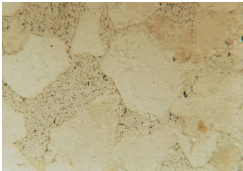
Pískovec křemenný středně zrnitý, silicifikovaný LU-1, zvětšení 32x, nikoly II zvýšená porozita, dotyková struktura úlomků – silicifikace (srůsty)
