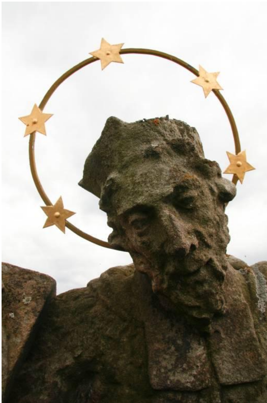
Fotografie č. 7 Detail hlavy sv. Jana Nepomuckého. Biologické depozity na povrchu kamene (mech, lišejník, krusty).
