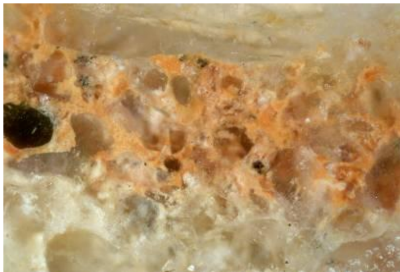
Vzorek č. 5 – sloup – na kameni pískovce je vrstva červené železité hlínky pravděpodobně ve vápenném pojivu (pozitivní test na železo po působení kyselinou chlorovodíkovou).
