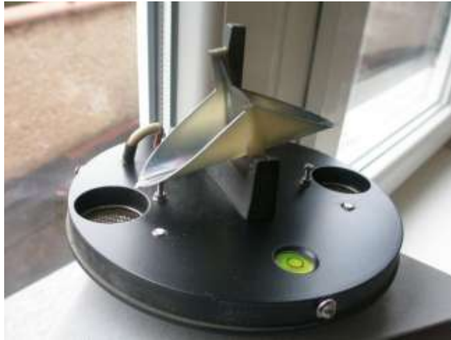
Obrázek 8 - Mechanismus člunkového srážkoměru.
