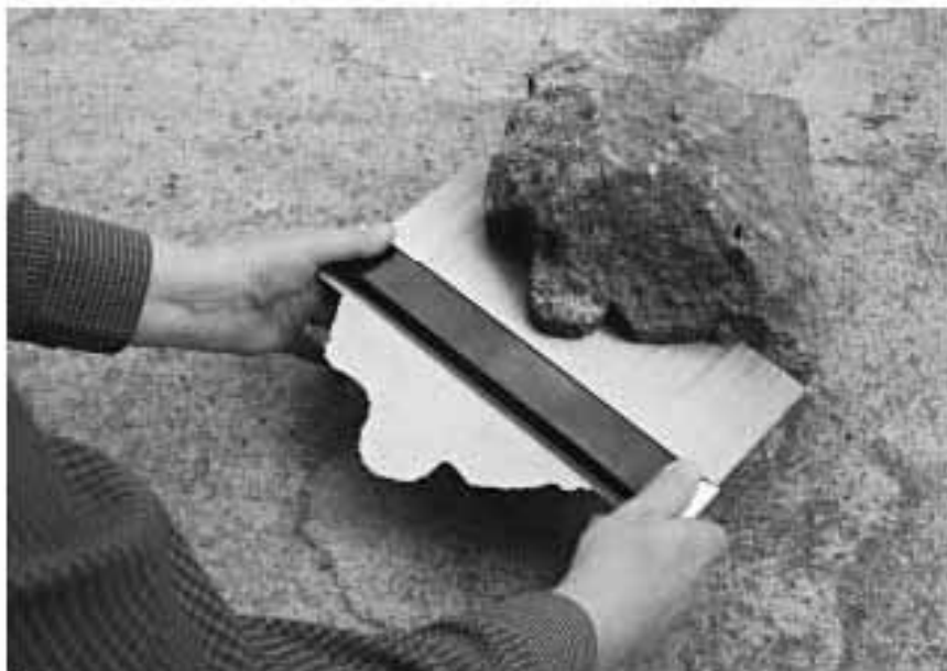
68. Měření profilace architektonických článků a dalších prvků je nejspíše proveditelné pomocí obrysové šablony s posuvnými jehlami (tzv. hrieben). Výsledek je vysoce přesný, a přitom dosažitelný s minimálními časovými nároky (což je právě při akci OPD žádoucí). Foto: J. Veselý, 2006.
