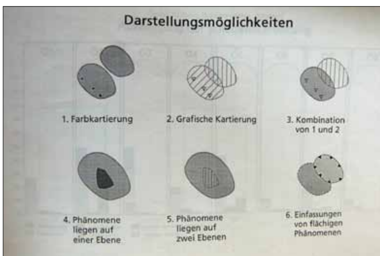
Obr. 104 a 105 – Příklad značek grafické dokumentace - Behrens, E., Kartieren mit System, Restaurierungswerkstätten, Institut für Denkmalpflege Hannover
