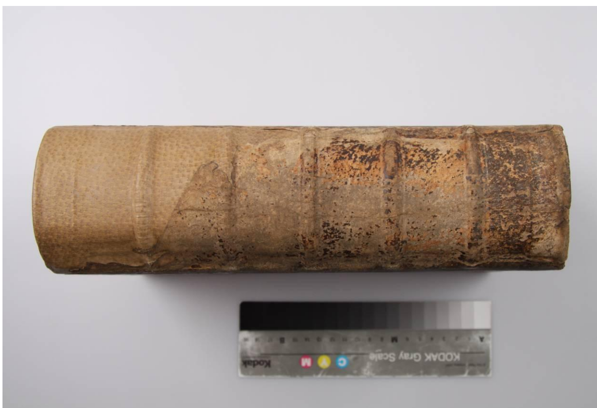
Obr. 32 Pohled na hřbetní část knižní vazby, stav po restaurování
