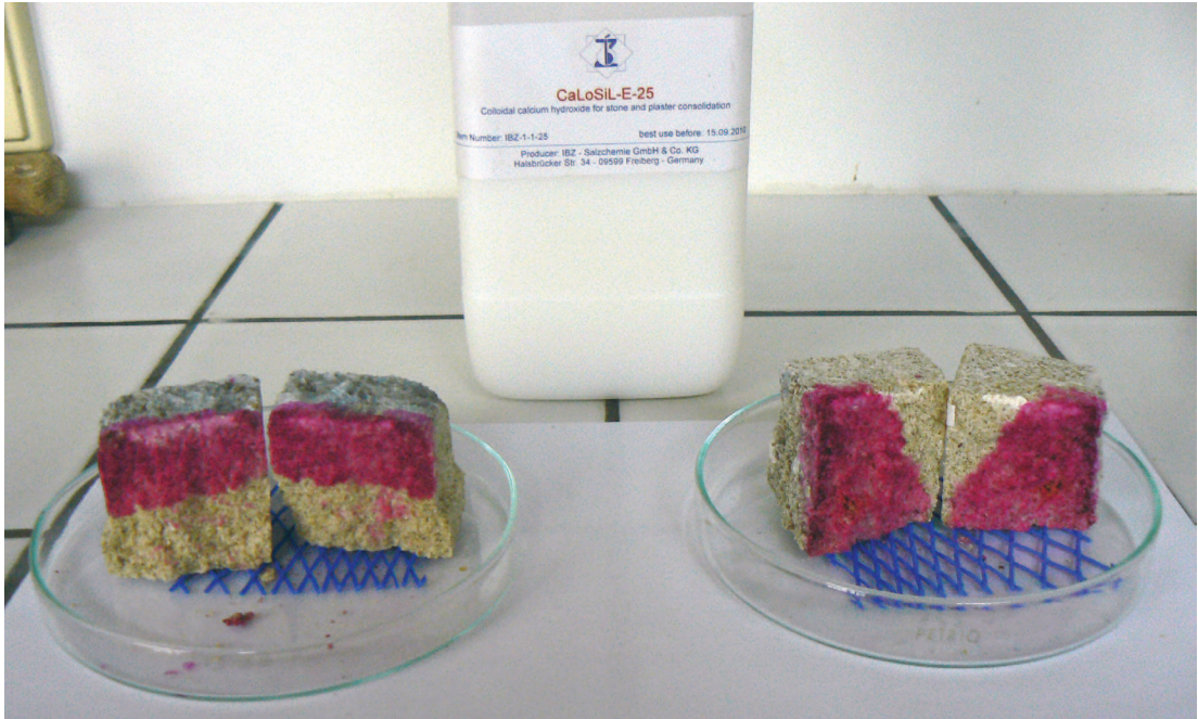
Vzorky vápence po aplikaci konsolidantu - test hloubky penetrace vzorky po aplikaci, rozlomení a vybarvení 1% fenolftaleinem; v levo aplikace na vodorovnou plochu, vpravo na svislou plochu
