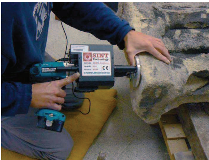
Obrázek 8 Měření přístrojem DRMS Cordless (SINT, I) na podstavě sochy anděla
