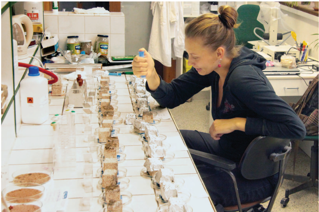
Napouštění 34 testovacích tělísek průběh napouštění
