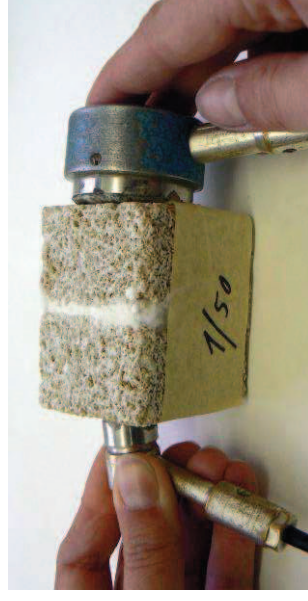
Měření UZ signálu po injektáži
