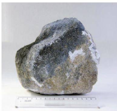
Detail - odlomený levý zadní roh podstavy zleva: stav fragmentu před restaurováním; stav fragmentu po konsolidaci a injektáži prostředky CaLoSiL - z vnější strany a z vnitřní (lomová plocha)
