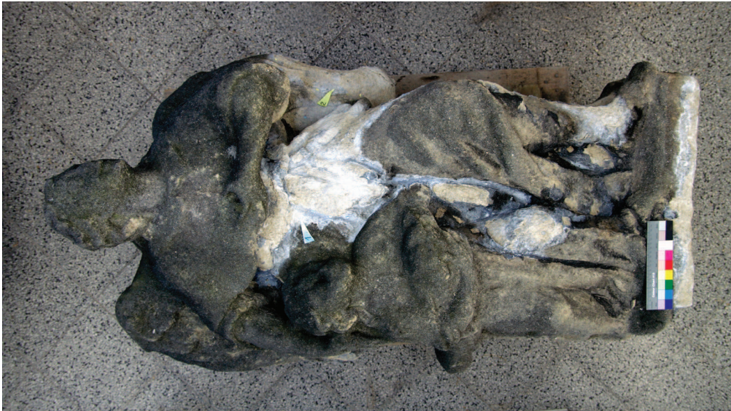
Socha anděla s dítětem; stav sochy v jednotlivých fázích konsolidace zleva: stav po 1. napouštěcím cyklu na definovaných plochách; stav po 2. napouštěcím cyklu na definovaných plochách; stav sochy po dokončení strukturální konsolidace prostředky CaLoSiL
