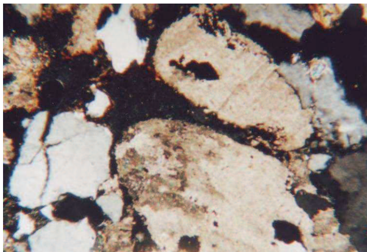
Obrázek 1 Vápenec biodetritický písčítý, hrubozrnný; zvětšeno 32x; nikoly X; struktura – opracovaný kalcitový biodetrit, křemenné klasty, hematit – limonit
