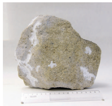
Detail - odlomený levý zadní roh podstavy zleva: stav fragmentu před restaurováním; stav fragmentu po konsolidaci a injektáži prostředky CaLoSiL - z vnější strany a z vnitřní (lomová plocha)
