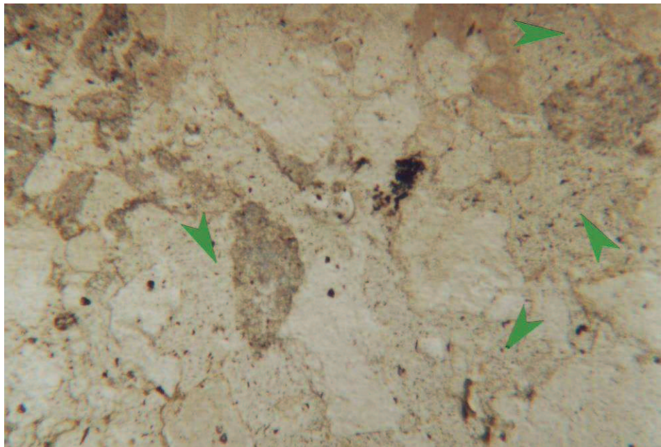
Vápenec biodetritický písčítý, hrubozrný zvětšeno 32x. nikoly II vysoká porozita mezi klasty
