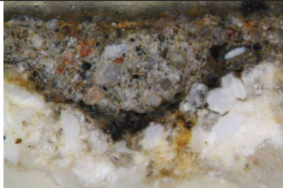
Obrázek 14 Vzorek V2 (5956); nábrus, optický mikroskop, dopadající světlo, fotografováno při zvětšení 50x
