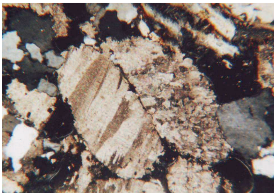
Vápenec biotritický písčítý, hrubozrný zvětšeno 32x. nikoly X struktura – opracovaný kalcitový biotrit, křemenné klasty
