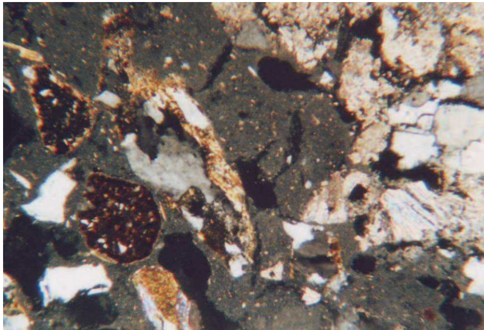
Malta mikritická – tmel? na povrchu kamene zvětšeno 32x. nikoly X struktura – mikritové pojivo s klastikou – pojivem (horniny, hutní struska)
