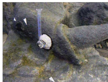
Obrázek 5 Měření nasákavosti Karstenovou trubicí na soše anděla
