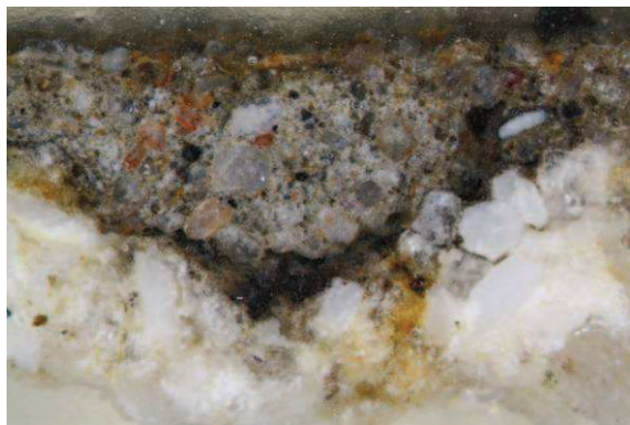
Obr.5. Nábrus, optický mikroskop, dopadající světlo, fotografováno při zvětšení 50x
