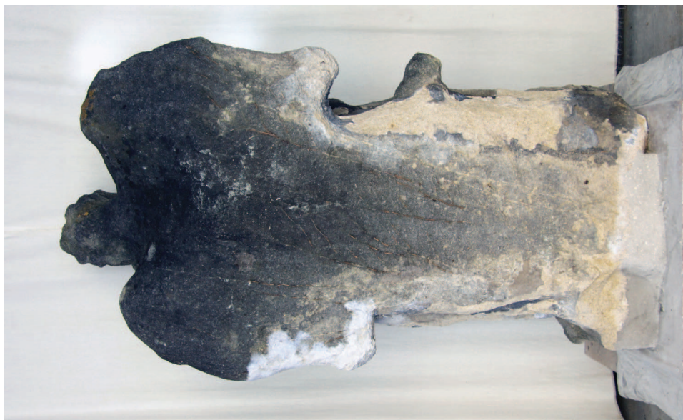
Socha anděla s dítětem zezadu; průběh prací zleva: stav po 2. napouštěcím cyklu na definovaných plochách, po dodání podstavy - vztyčení objektu (ještě bez osazeného levého zadního rohu); po dokončení konsolidace, zkouška mokrého čištění (obdélník), poloviční čištění zad mokřými metodami (již s osazeným levým rohem); po mokřém čištění
