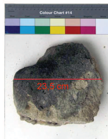
Obrázek 38 Fotografie levého zadního rohu podstavy, který byl také napouštěn v první konzervační fázi
