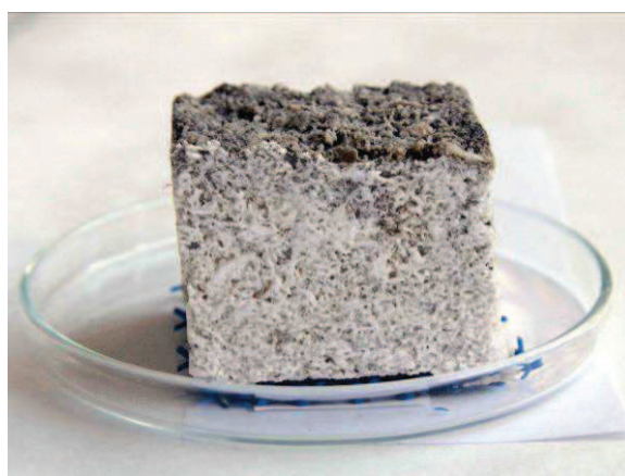
Obrázek 23 Laboratorní vzorek s korodovaným povrchem
