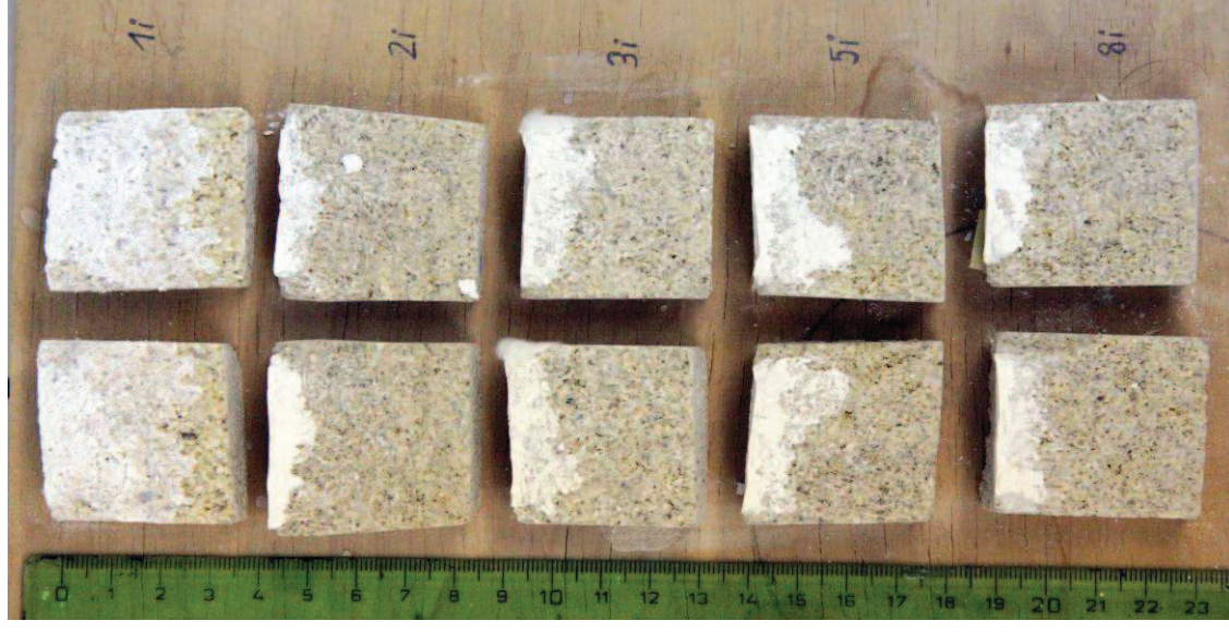
Ukázka injektovaných vzorků po rozlomení; pouze směsi, které nepopraskaly
