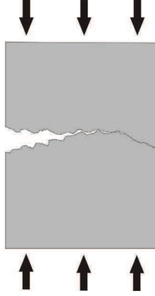
Příčný řez vzorkem s imitovanou prasklinou; naznačení směří měření UZ signálu
