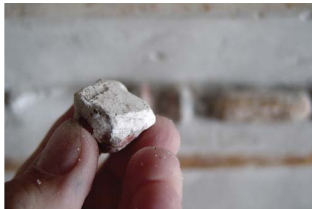
Obr. 48 - Odstraněná kulička s nánosem sádry.
