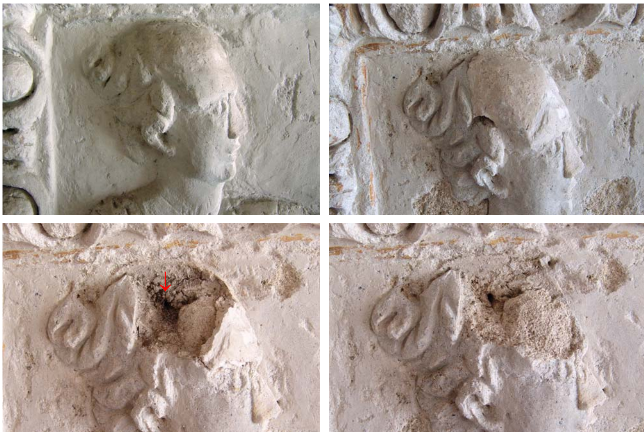
Obr. 42 - Postup odstraňování pačoku a sádrových doplňků
