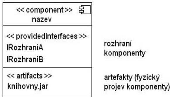
Obrázek 11: Příklad komponenty jako bílé skříňky v UML
