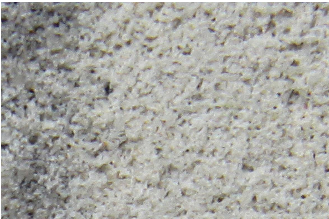
Snímek 24 - makroskopický stav povrchu vzorku 2. (Sokrat 2802 NA), stav po ukončení simulace
