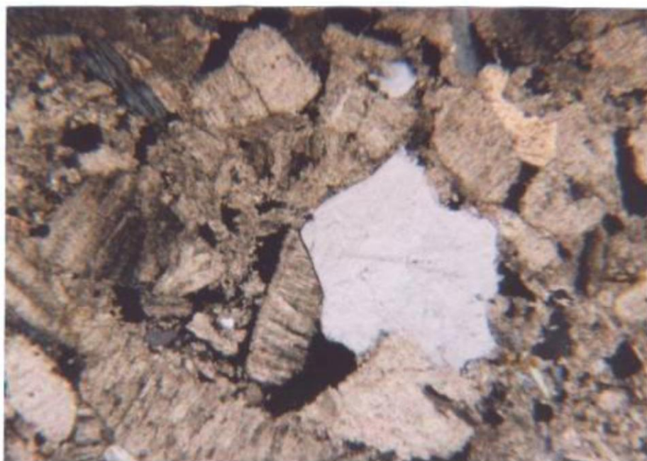
Vápenec biodetritický, hrubozrný, porézní typ vzorek P-1, zvětšení 32x, nikoly X sparitový biodetrit (kalcit), křemenná klastika, póry (černá)
