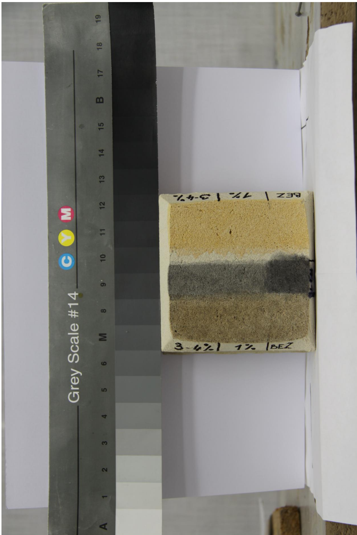
Snímek 7 – stav vzorku 1. po nanesení barevné retuše, stav před započítím simulace srážkové vody
