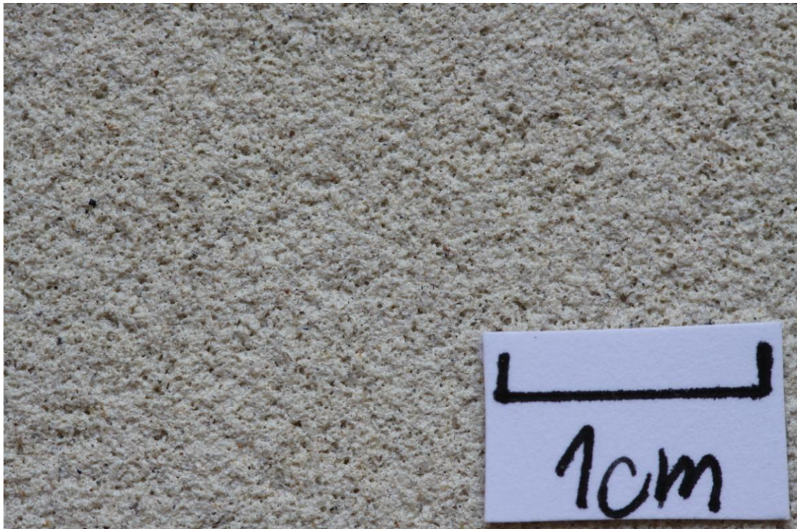
Snímek 4 – struktura „umělého kamene“ před započítím simulace srážkové vody
