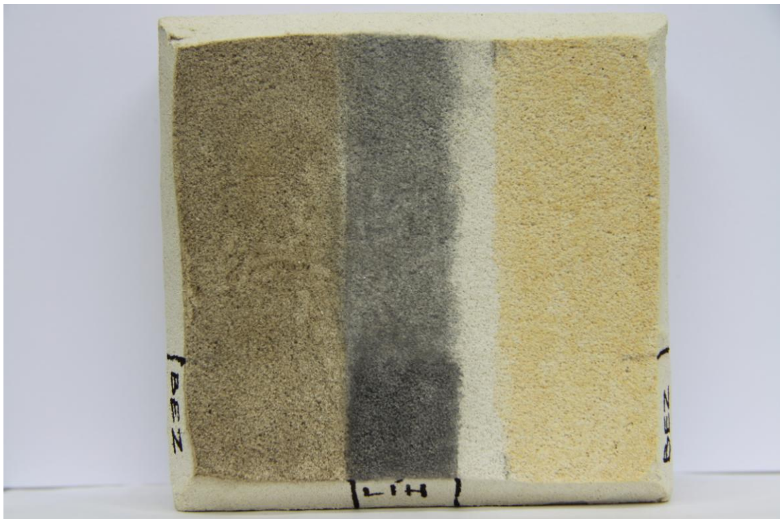
Snímek 15 - srovnání stavu vzorku (KSE 300), nahoře stav před, dole po ukončení simulace
