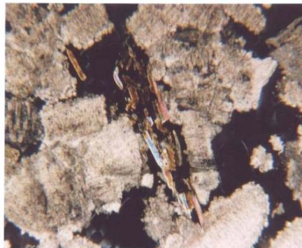
Vápenec biotrititický hrubozrný, homogenní typ vzorek P-4, zvětšení 32x, nikoly X degradace slídivého materiálu (muskovitu)
