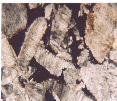
Vápenec biotrititický hrubozrný, homogenní typ vzorek P-4, zvětšení 32x, nikoly X dekalifikace tmelu – maximální porozita
