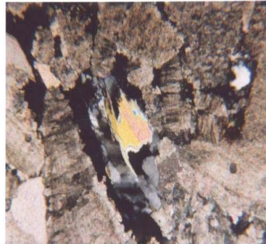
Vápenec biotritický hrubozrný, homogenní typ vzorek P-4, zvětšení 32x, nikoly X struktura sparitového vápence, horninové klasty
