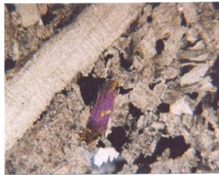
Vápenec biotritický, hrubozrný, porézni typ vzorek P-2, zvětšení 32x, nikoly X kalcitový (sparitový) biotrit, křemenná klastika, slída (muskovit)
