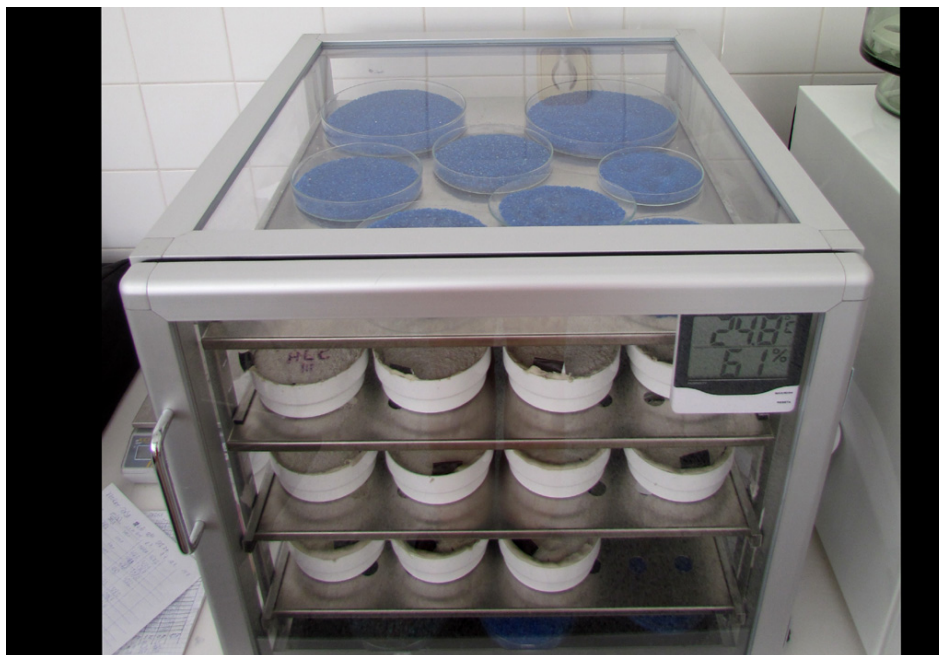
tmely umístěné v klimakomře- test paropropustnosti
