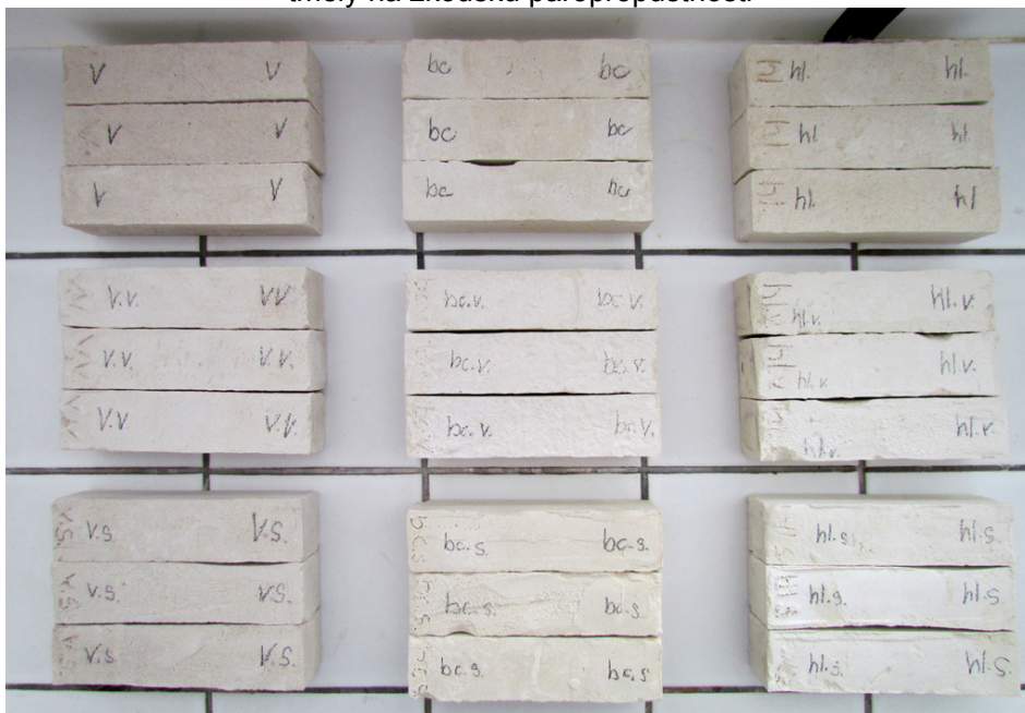
tmely na zkoušku pevnosti tahu za ohybu
