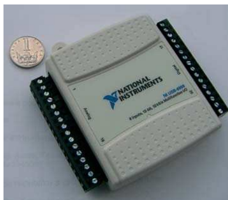
Obr. 1.3 – Zařízení NI USB-6009 pro sběr dat
