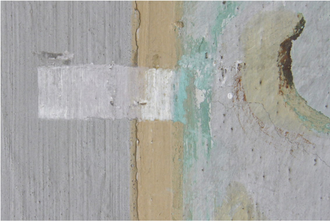
Obr.46: Sonda č. 4 odhalila původní světlejší barevnost, dochovanou pod mladší barevnou vrstvou šedého rámování okolo malby. Sonda byla provedena při pravém okraji malby.
