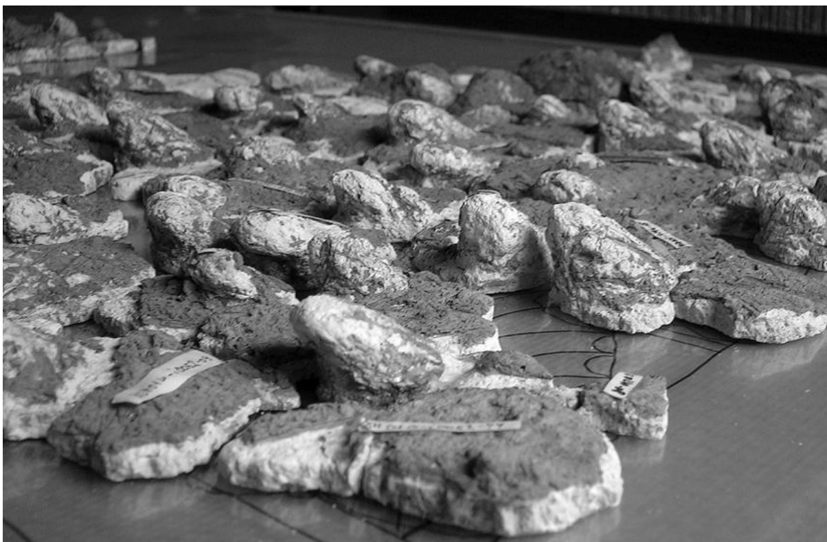
Obr. 52 Qatna, rub omítkových fragmentů s obtisky prstů, které zaručovaly lepší adhezi mezi jílovým arricciem a vápenným intonacem, Zdroj: http://archiv.ub.uni-heidelberg
