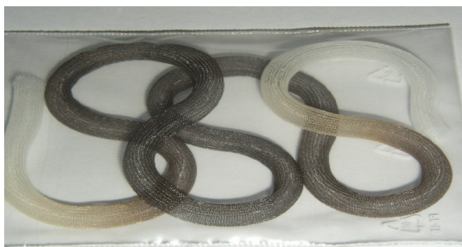
Obr. 25.: Textilní cévní implantát pokrytý tenkou vrstvou diamantu podobného uhlíku [41]
