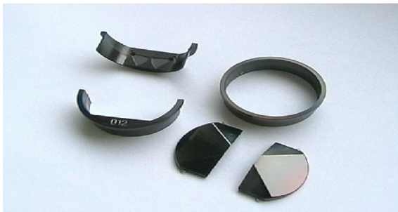
Obr. 24.: Umělé srdeční chlopně pokryté DLC [37]
