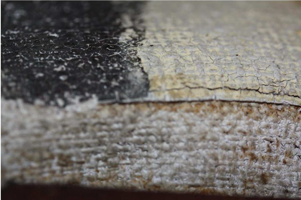
Foto. 37. Detail nahromadění šepsu při okraji profilové lišty výplně.
