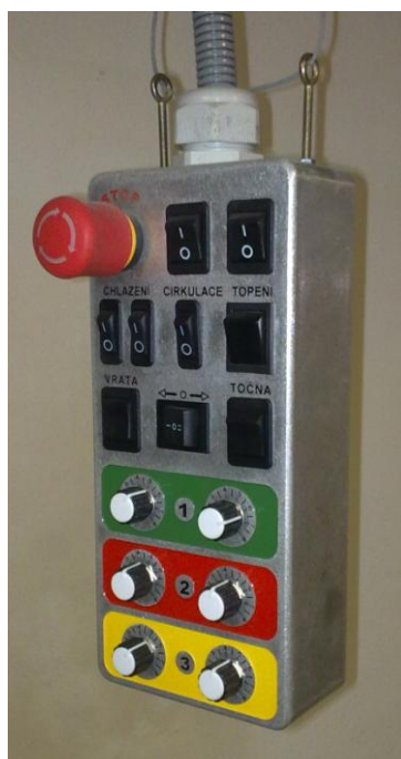
Obrázek 15: Provedení OVLÁDACÍHO PANELU
