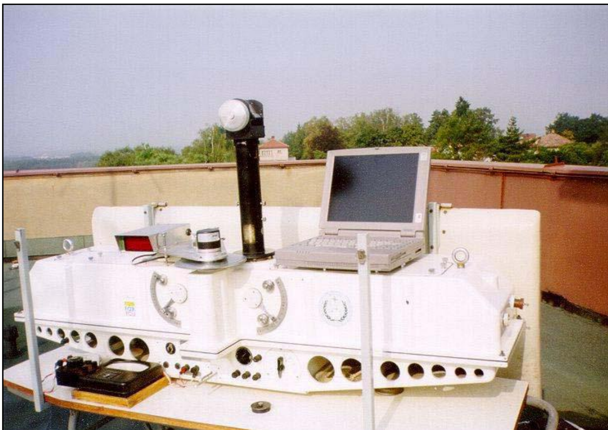
Obr. 1 Dobsonův spektrofotometr č. D074 používaný v ČHMÚ k měření celkového ozonu, zdroj: [9]
