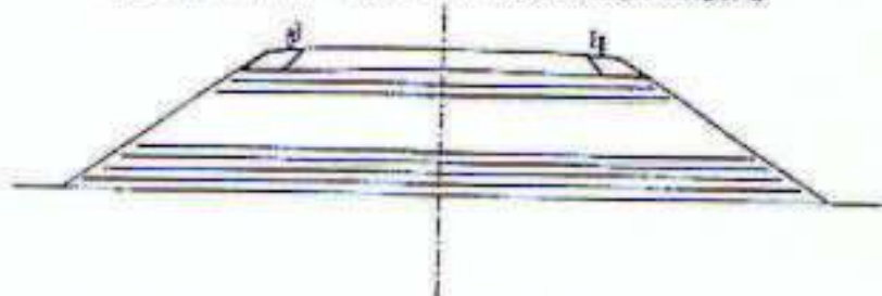
VÝZTUŽNÉ PRVKY V URČITÝCH OBLASTECH NÁSYPU
