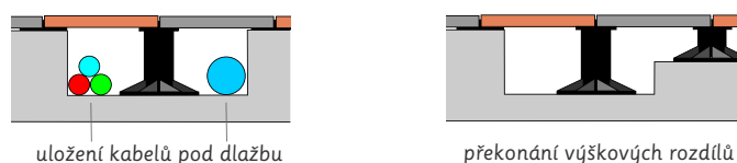
Příklad pokládky dlažby na distanční a rektifikační terče:
