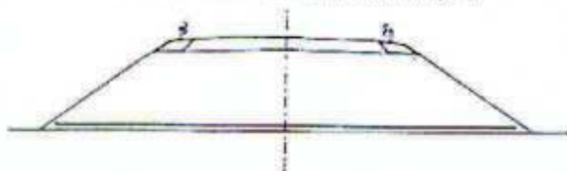
VYZTUŽENÁ VRSTVA VE SPODNÍ ČÁSTI NÁSYPU
