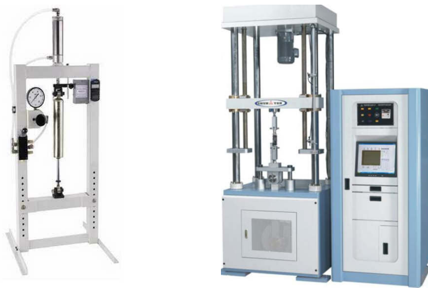
Obrázek 13 – Pneumatický zkušební stav E-5 Shock Dyno (vlevo), Hydraulický zkušební stav CY-6781 (vpravo) [13, 14]
