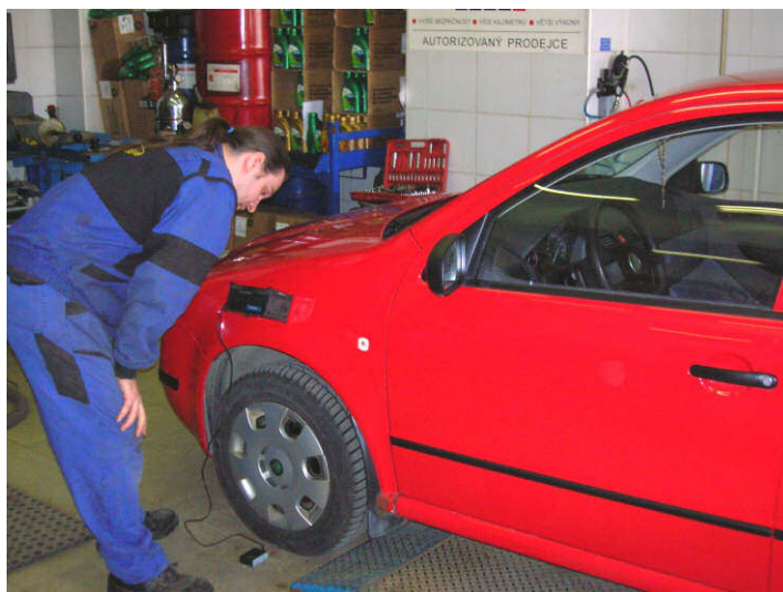
Obrázek 25 – Manipulace obsluhy s měřícím přístrojem M-Tronic SDT 2000/U
