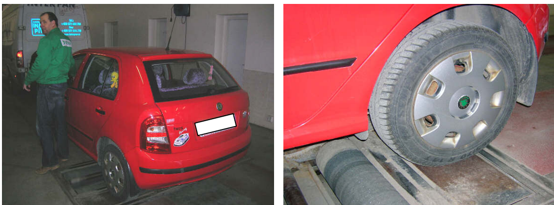
Obrázek 20 – Práce obsluhy s vozidlem (vlevo), detailní pohled na měřené levé kolo zadní nápravy (vpravo)
