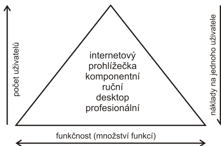
Obr. 1 - Typy GIS řešení podle počtu uživatelů, nákladů na uživatele a počtu nabízených funkcí (zdroj: převzato z [9])
