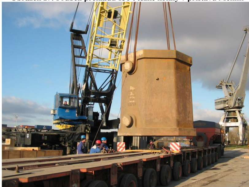
Obrázek 17: Průběh překlady 136 t těžké kokily v přístavu Mělník
