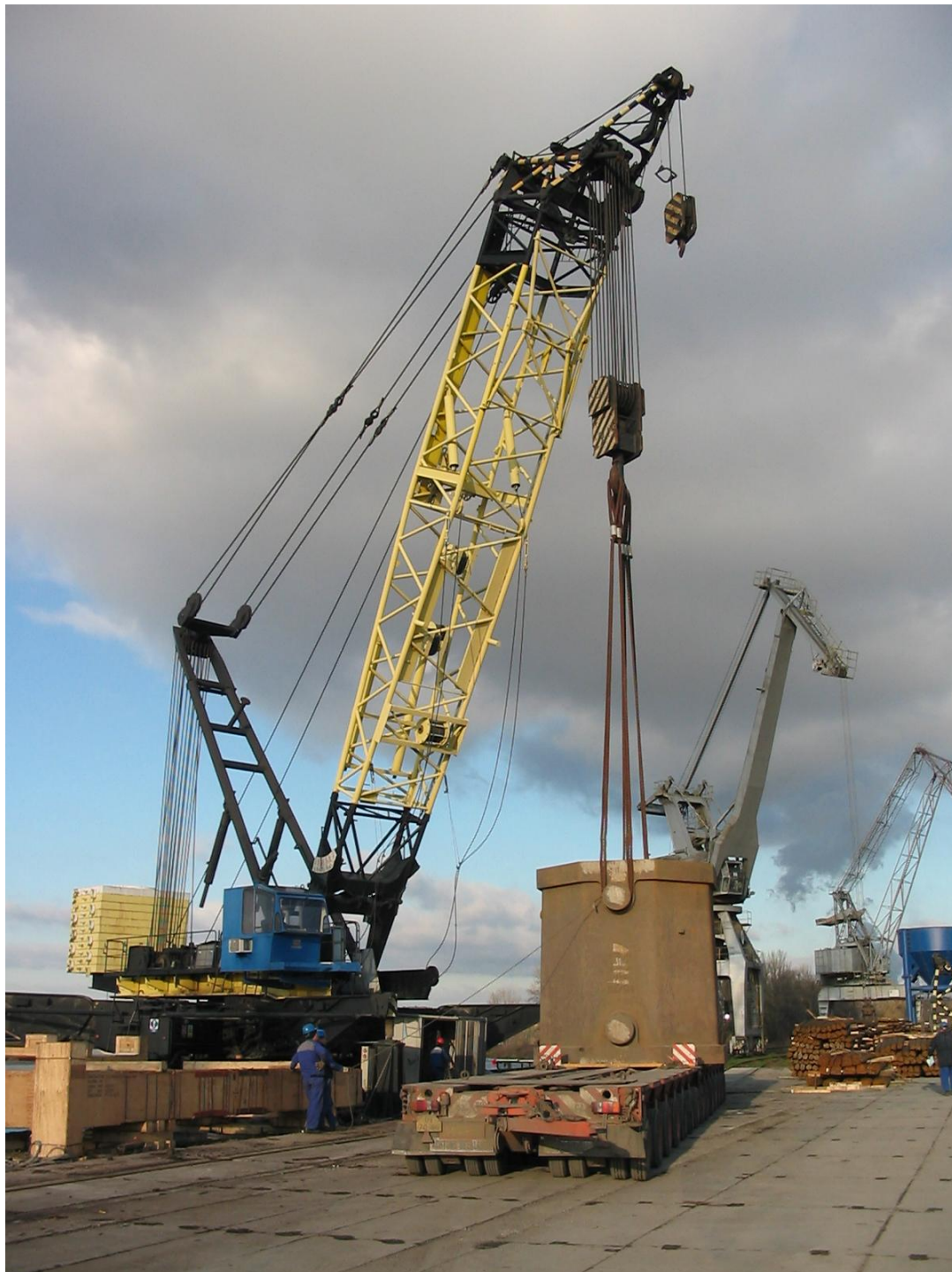
Obrázek 18: Jeřáb MKZ-3000 o nosnosti 300 t v akci
