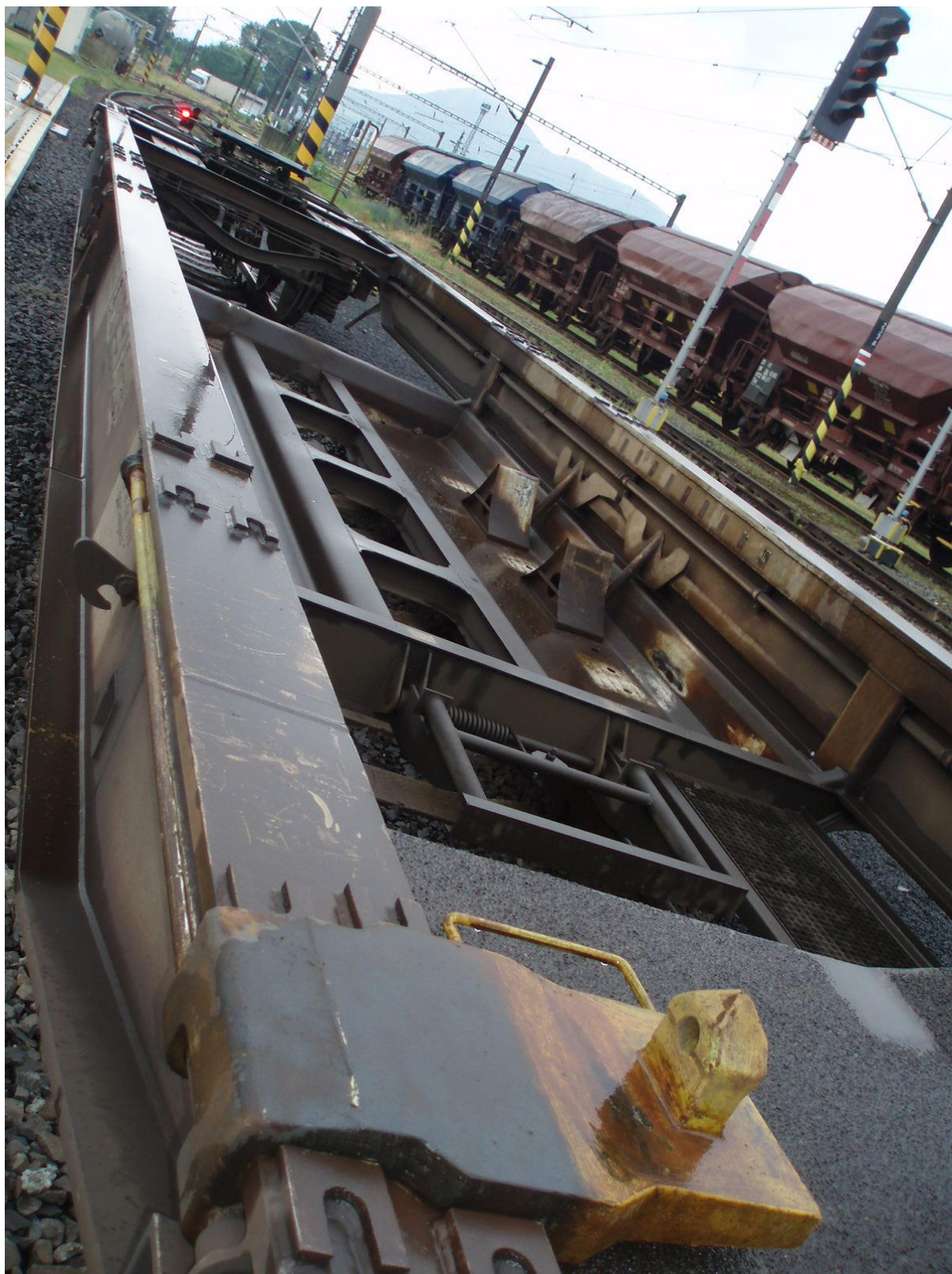
Příloha 2.6: železniční vůz Sdggmrss megapack, jeho posuvné části a pozice pro jejich umístění
