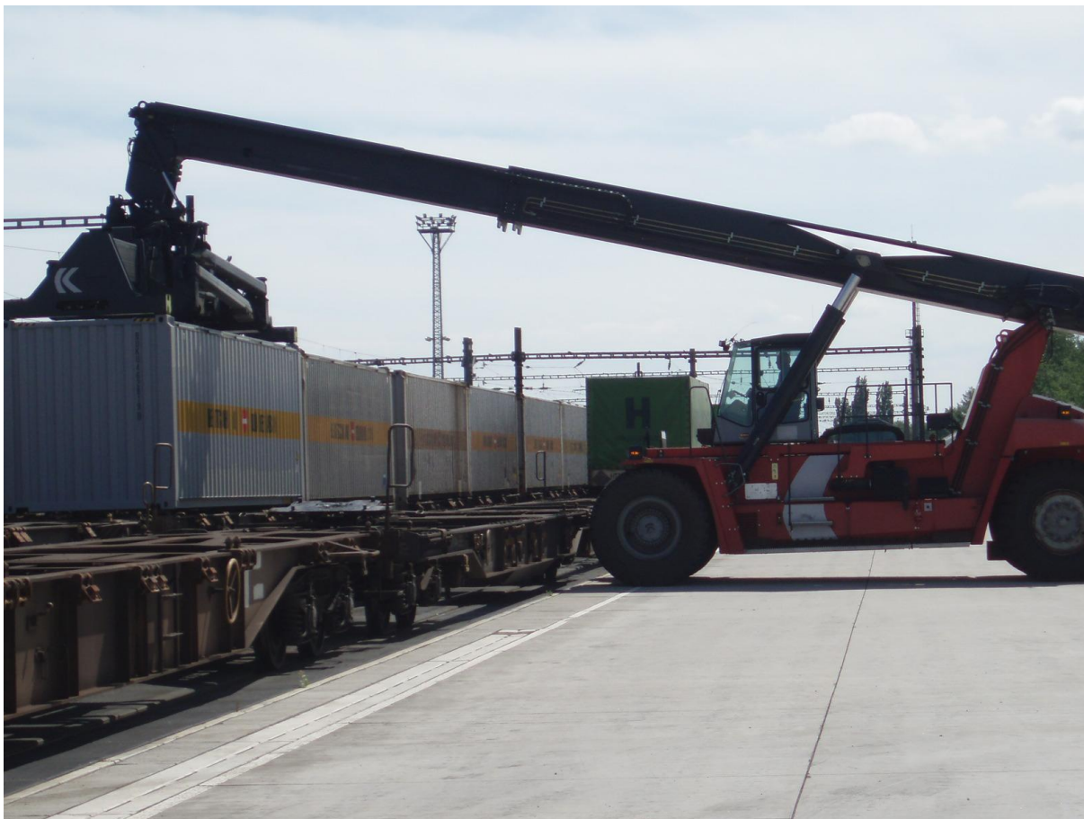
Příloha 1.5: Překládka 30' kontejneru ze železničního vozu z druhé koleje
