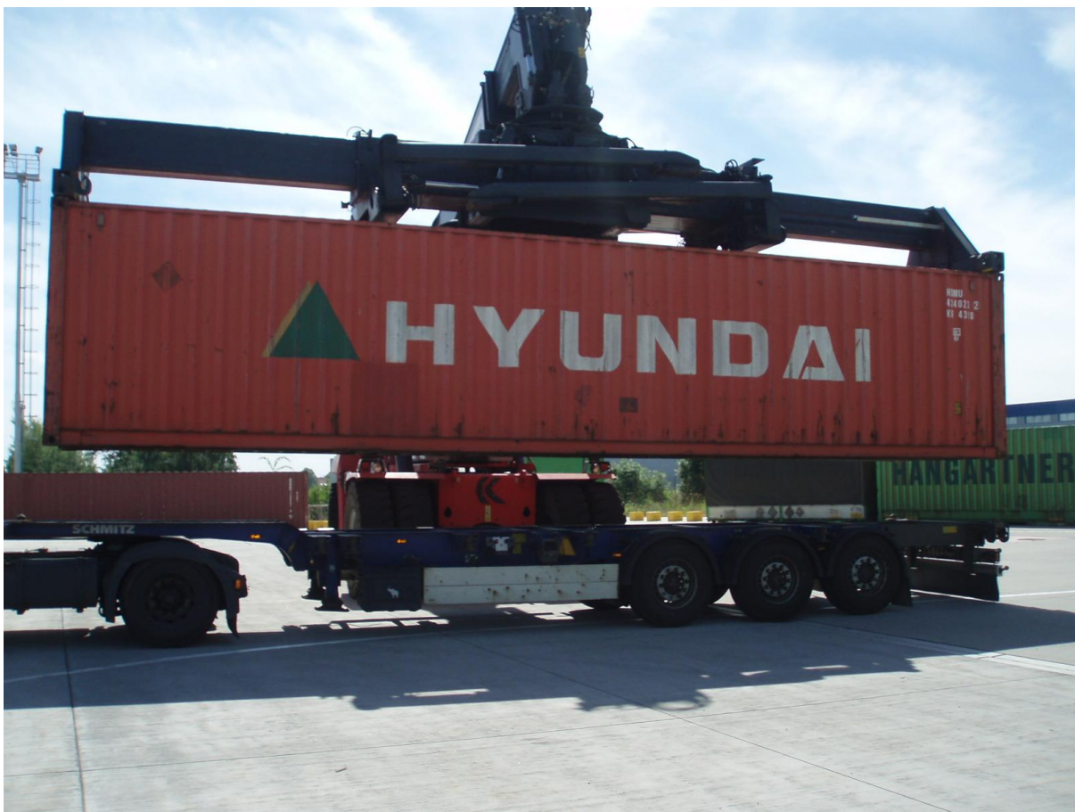
Příloha 1.4: překládka 40' kontejneru ze silničního vozidla
