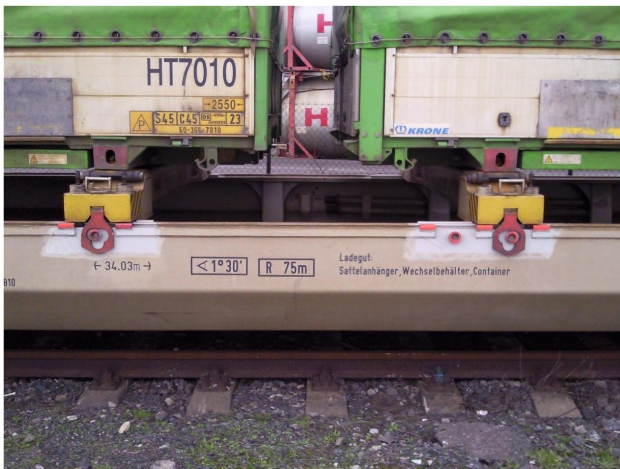
Příloha 2.4: umístění výměnných nástaveb na voze Sdggmrss TWIN s pomocí příčných rámců
