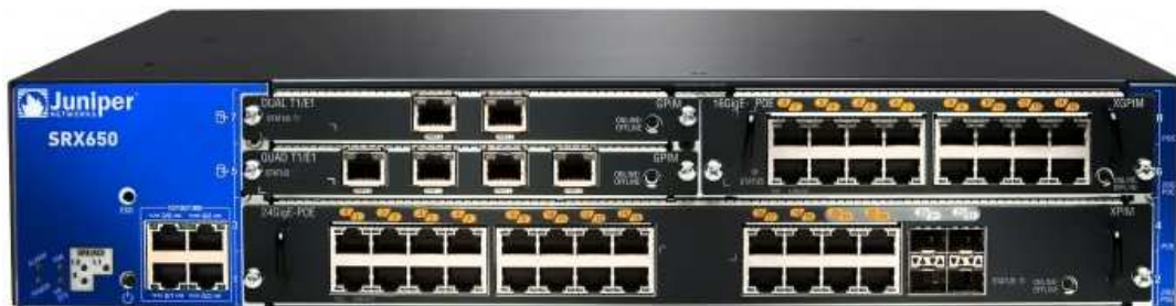
Obrázek 9. Juniper SRX 650 servisní gateway firewall 2GB propustnost 7 Gbits (zdroj: < www.64bit.eu >)
