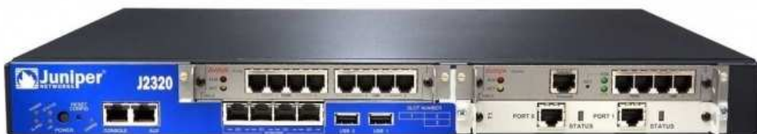
Obrázek 7. Juniper J Series J2320 router 512 MB RAM (zdroj: <www.64bit.eu>)
