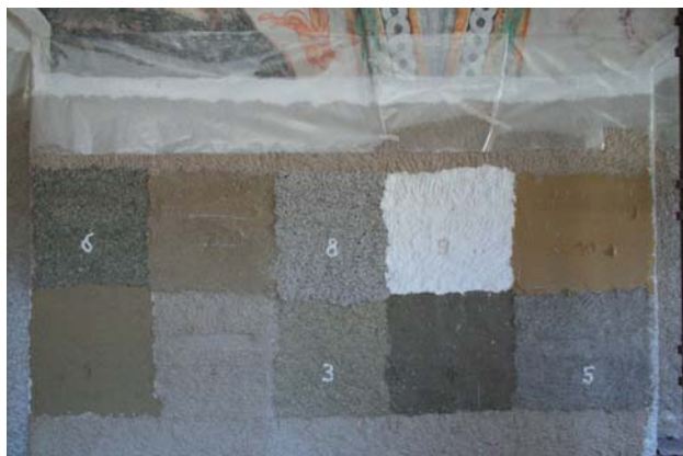
obr.15 Přípravné vzorky odsolovacích směsí
