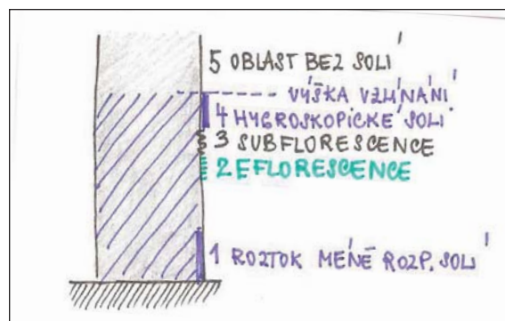
obr.2 Schéma zasolené zdi
