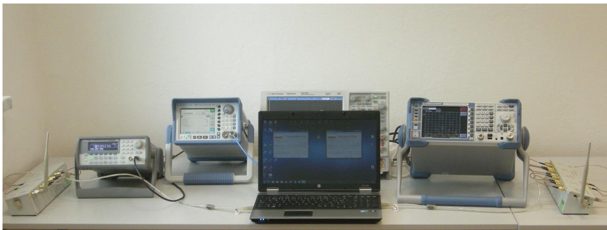
Obr. 5.4 Laboratorní pracoviště, část modulace nosného signálu a vlastního přenosu signálu bezdrátovým komunikačním systémem
