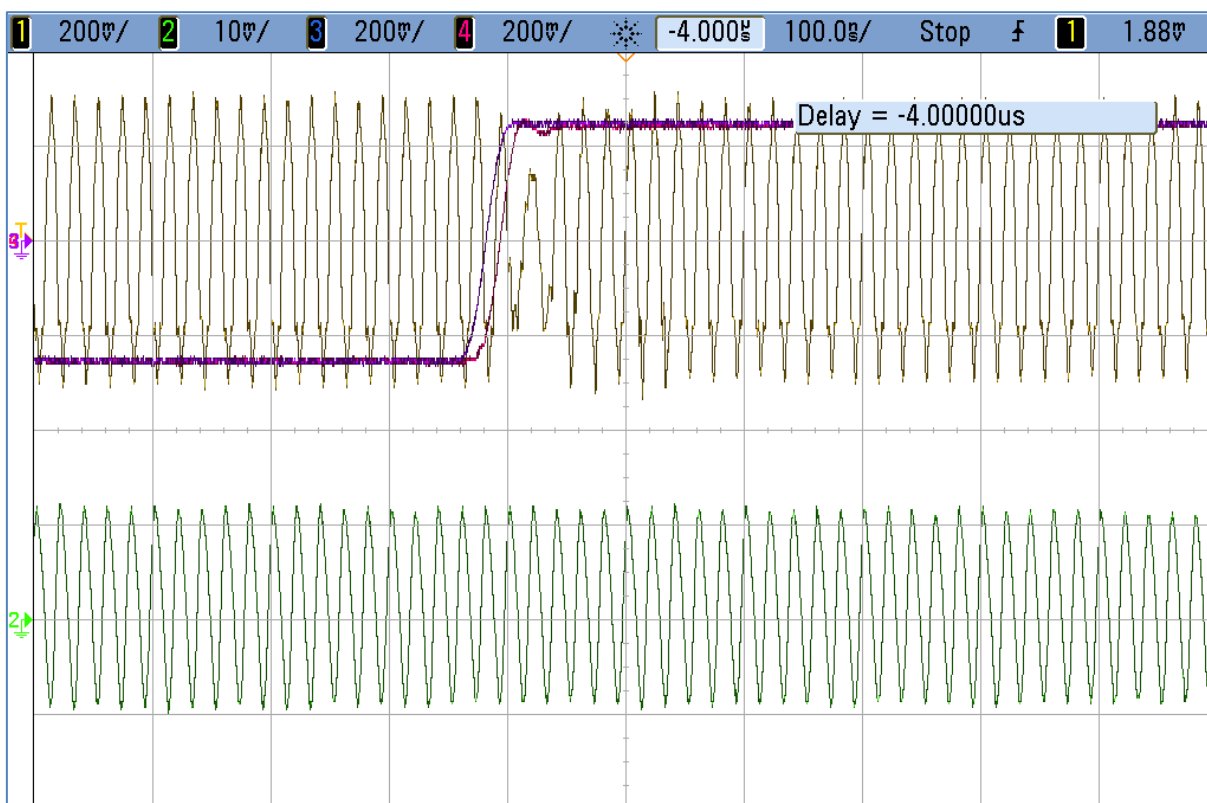
Obr. 6.9 Změna fáze modulace BPSK, detail signálu před rádiovou cestou
