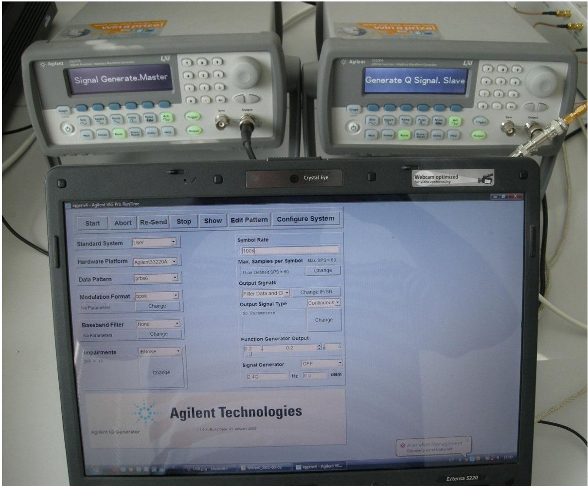
Obr. 5.2 Laboratorní pracoviště, část generování IQ složek signálu
