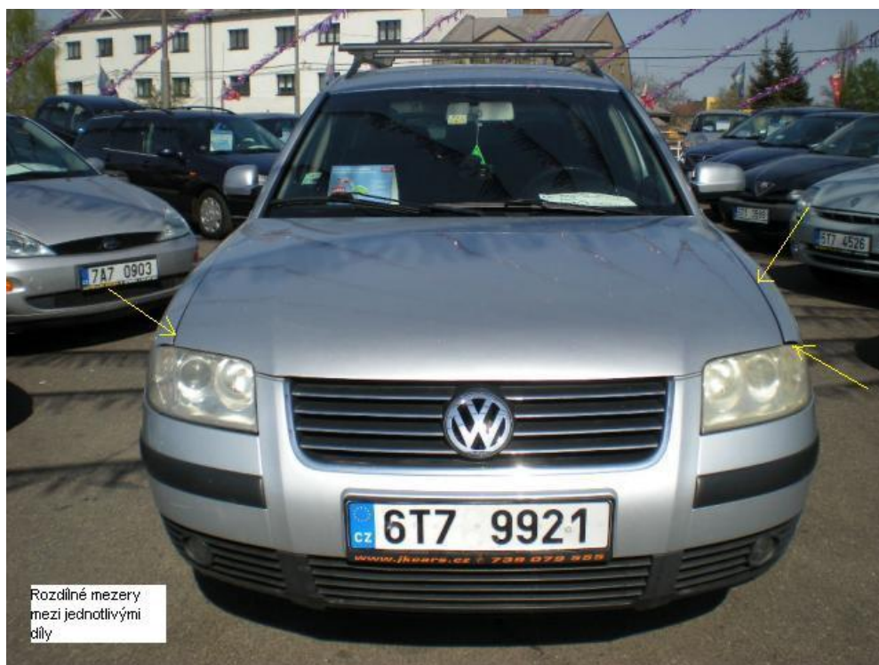
Obr. 10 - Nepřesné spasování dílů vozidla
