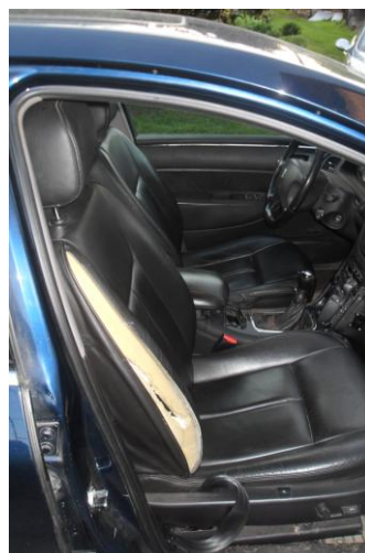
Obr. 14 - Poškozené sedadlo od airbagu
