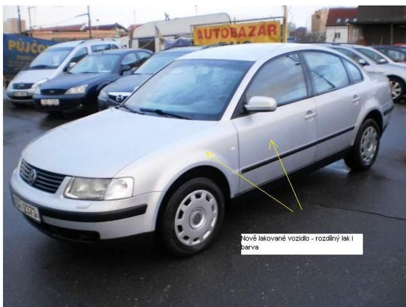
Obr. 12 - Rozdílný odstín i barva vozidla
