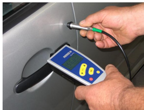
Obr. 11 - Příklad přístroje na měření vrstvy laku [2]
