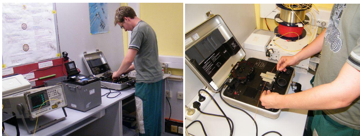
Obrázek č. 11 - Učebna odborného výcviku – žák při sváření optického vlákna
