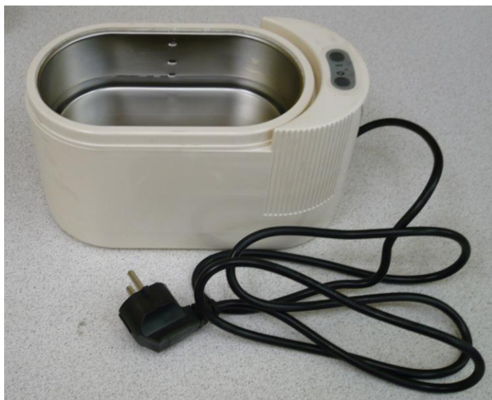
Obr. 13b: Ultrazvuková lázeň pro odplynění vzorků [vlastní foto]
