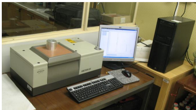
Obr. 16: FTIR spektrometr Vector 22 s HATR-jednotkou [vlastní foto]
