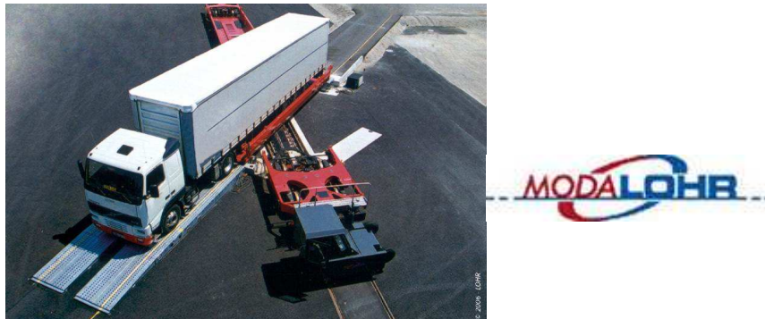
Obr. 33: Nakládka návěsu na železniční vůz v systému ModaLohr
