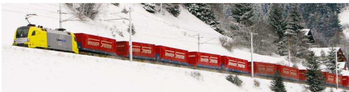
Obr. 32: Shuttle vlaky nedoprovázené kombinované přepravy
