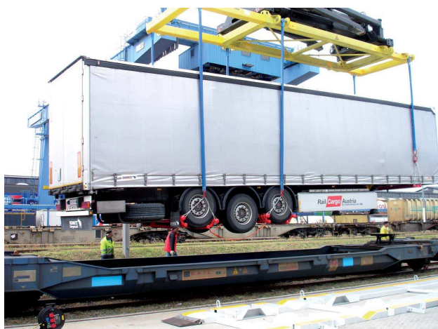
Obr. 36: Překládka silničního návěsu systémem ISU
