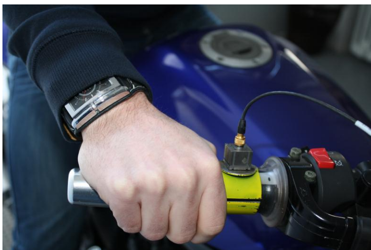
Proces měření – nutné zatížení tělem pro simulaci reálného zatížení v provozu
