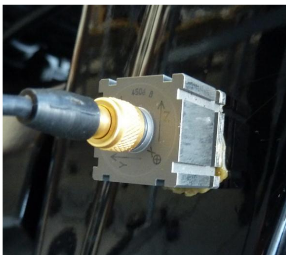
Obr. 20 Snímač přilepený včelím voskem přímo na motocyklový rám
