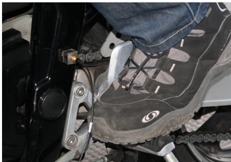
Snímač umístěný na motocyklovém rámu vzadu
