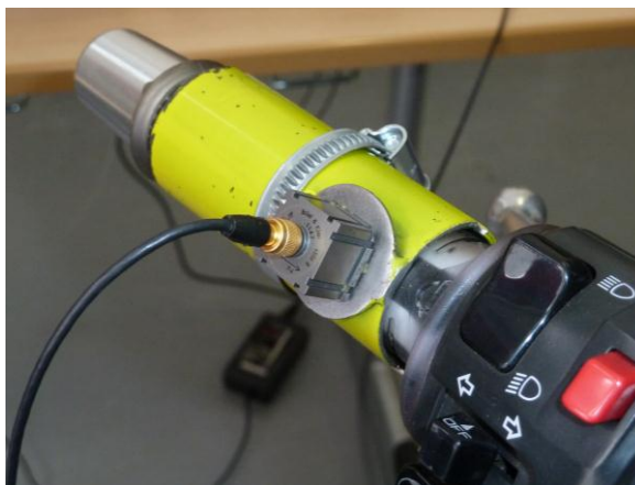
Obr. 22 Úchyt pro měření vibrací na řídítkách
