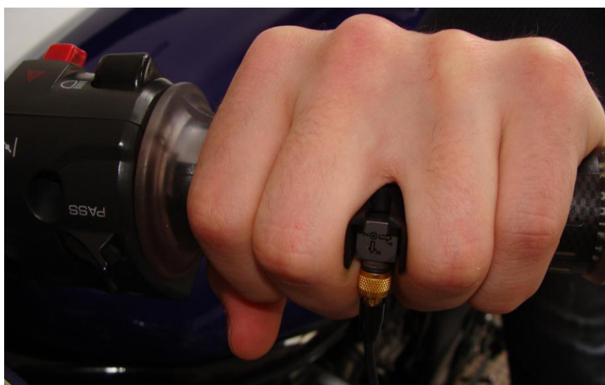
Uchopení snímače v průběhu měření
