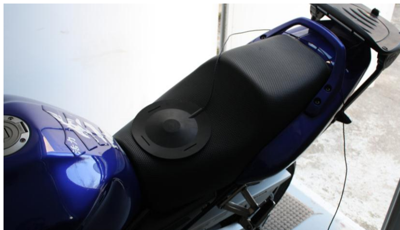
Obr. 23 Umístění impaktoru na motocyklovém sedadle
