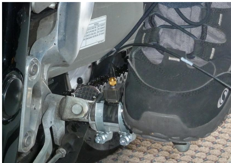
Zatížení stupačky vahou řidiče v průběhu měření
