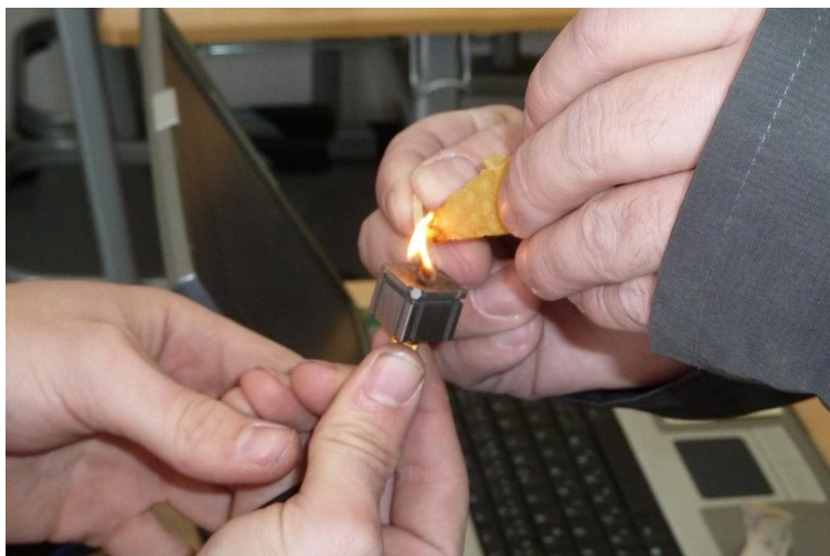
Nahřívání včelího vosku a jeho aplikace na snímač
