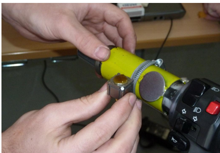
Lepení snímače na levou rukojeť řídicí
