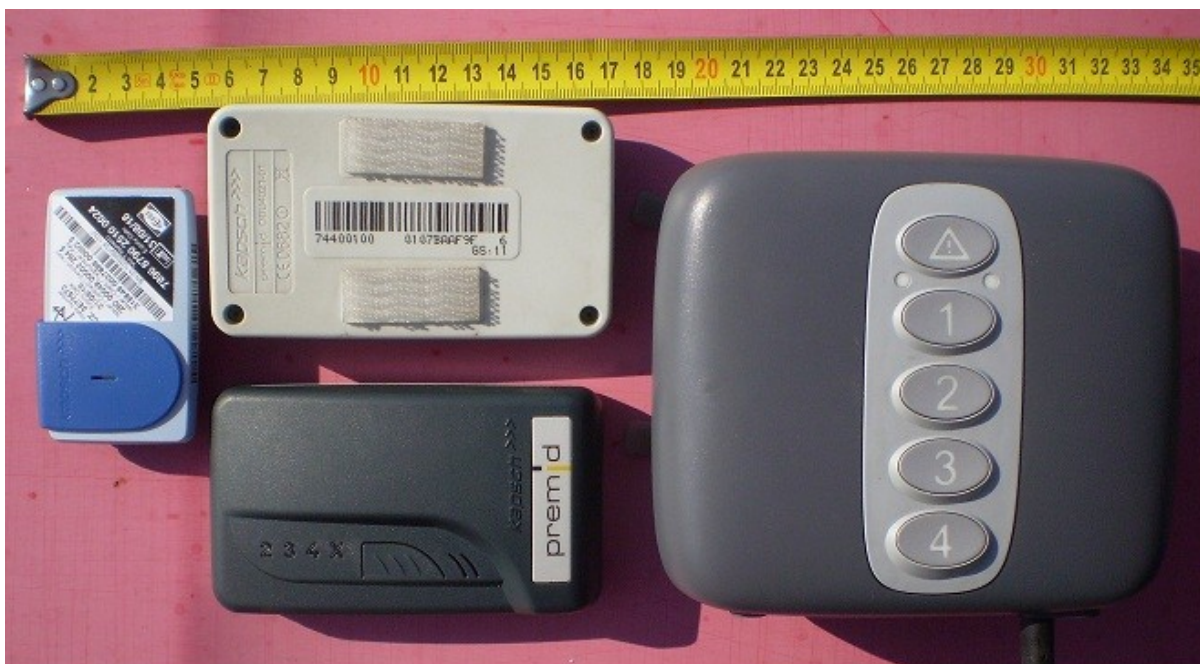
Obr. 3: Velikost palubních jednotek zabírajících místo ve výhledu z vozidla
