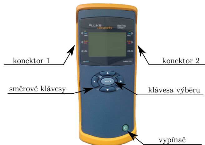
Obrázek 8 – Ovládací prvky NetTool series II
