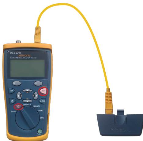
Obrázek 2 – Autotest kabelu s připojeným wiremap adaptérem
