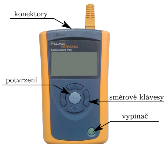
Obrázek 6 – Ovládací prvky LinkRunner Pro
