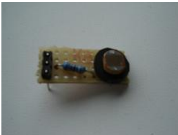
Obr.: 2.05 – Nezakrytovaný upravený optický senzor s fotorezistorem.
