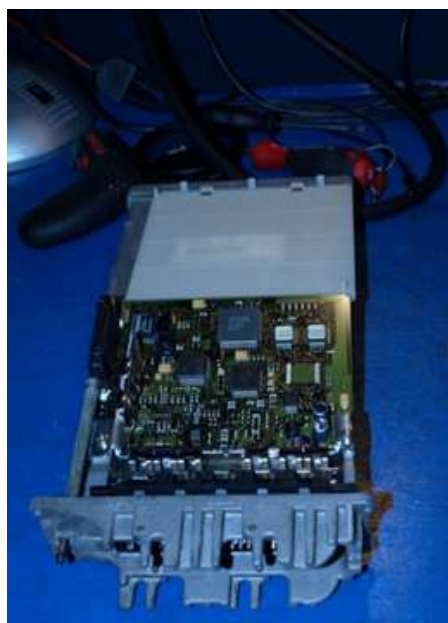
Obrázek 25: Elektronická řídicí jednotka BOSCH s odstraněným vrchním krytem.
