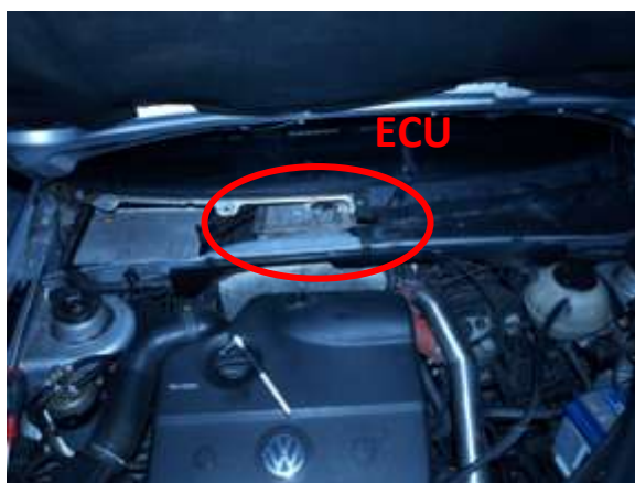
Obrázek 23: Umístění elektronické řídicí jednotky ve vozidle VW Golf III. generace TDi
