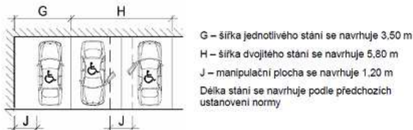
Obrázek 7 – Prostorové uspořádání parkovacích stání s kolmým řazením pro vozidla přepravující osoby těžce pohybově postižené
