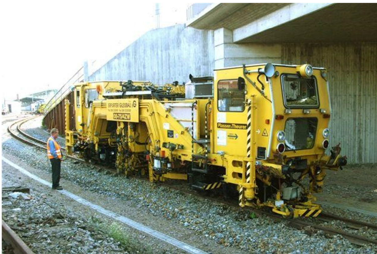
Obr. 13 Podbíječka firmy Plasser & Theurer Plassermatic 08-75/4 ZW [foto: Weißeritztalbahn]
