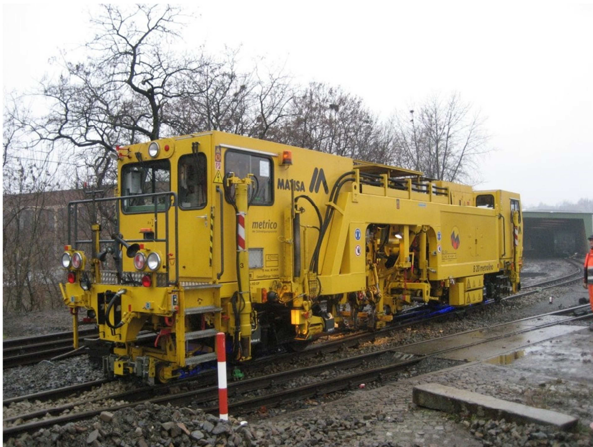
Obr. 14 Podbíječka firmy MATISA B20 AC-4 METROLINO [foto: Steffen Eule]
