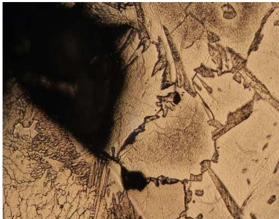
Obr. 24 – Mezikrystalická koroze, mikroskopické metalografické hodnocení [21]
