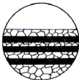
Obr. 14 – Koroze po vrstvách [6]
