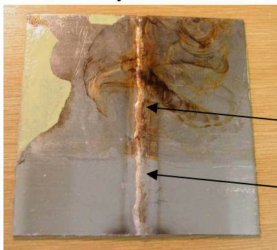
Obr. 18 – Náběhové barvy materiálu 1.4016 (feritická nestabilizovaná ocel)
