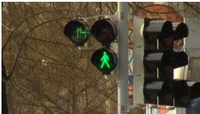
Obr. č. 4: Semafor s časovou signalizací Zdroj: (38)
