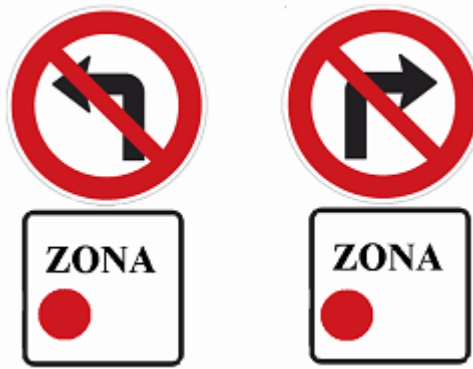
Obrázek 11 : Návrh dodatkové tabulky pod zákazovou dopravní značku B 24a a B 24b. Barevné označení určuje emisními známkou.
