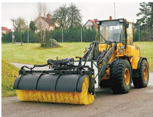
Obrázek 8 - Použití kroužkových kartáčů
