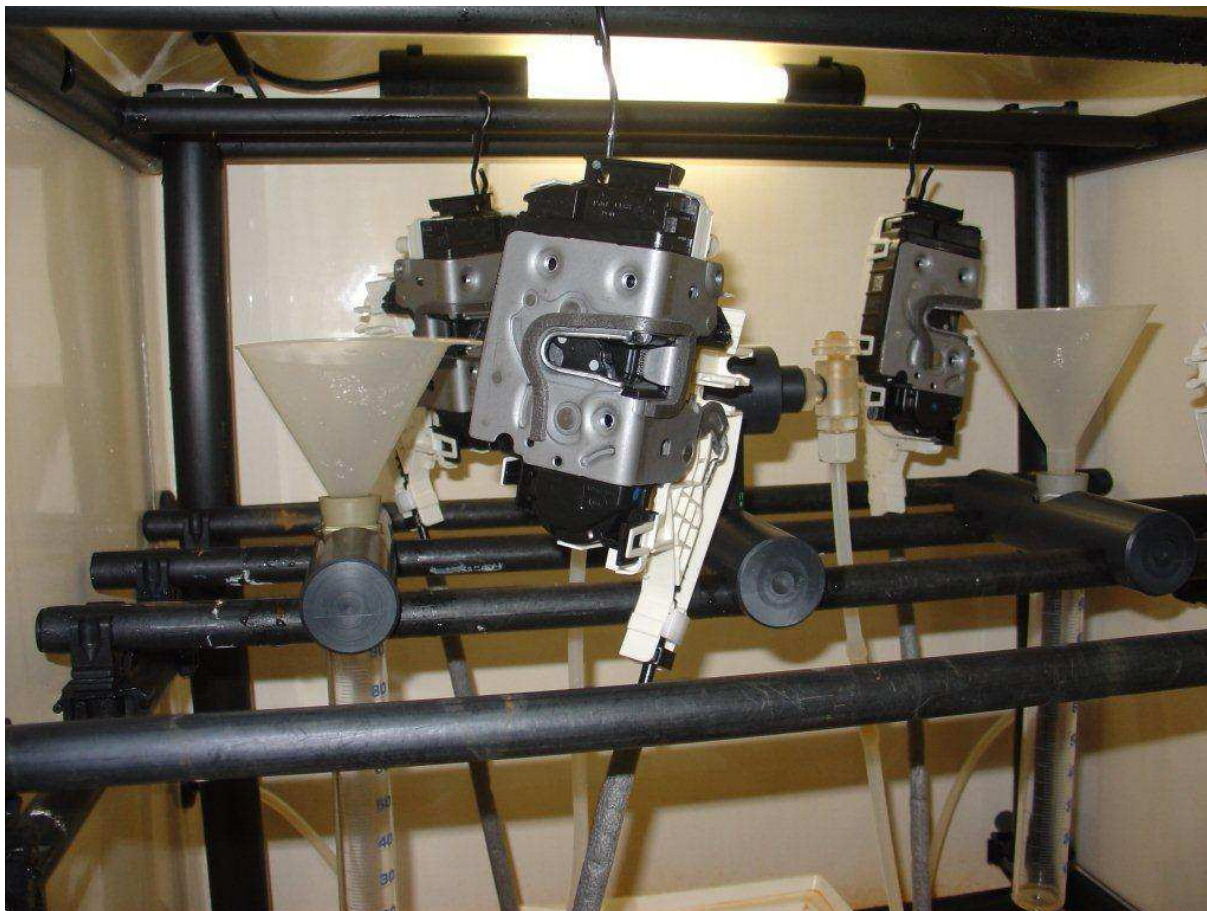
Obrázek č. 20 - Zavěšení zámků v solné komoře
