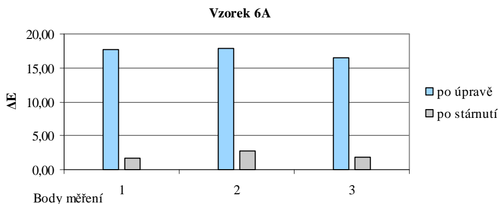
Graf 16: Barevné odchylky po úpravě a stárnutí - 20% Lukosil M 130
