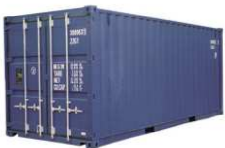
Obrázek č. 7 - Kontejner ISO řady 1 pro všeobecné použití [23]
