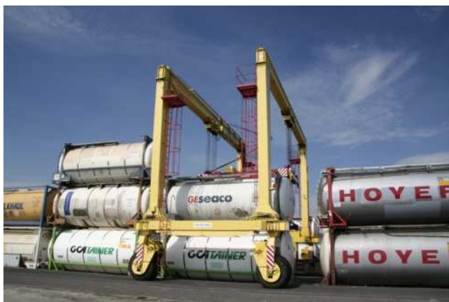
Obrázek č. 1 Portálový jeřáb na pneumatikách s vrchním spreaderem [9]
