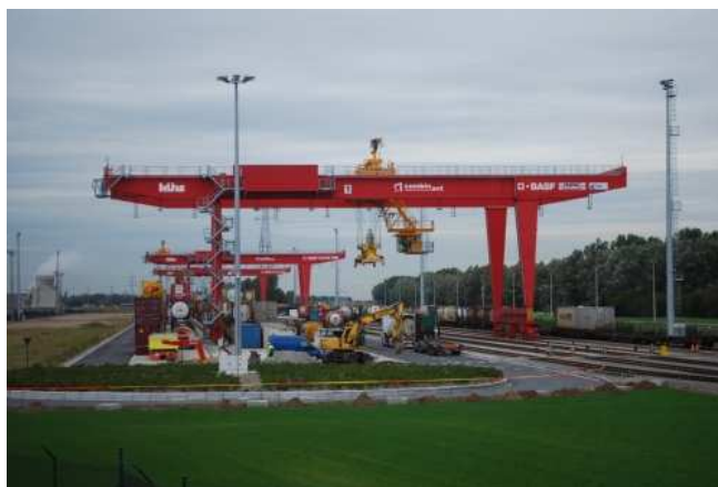
Obrázek č. 2 - Portálový jeřáb s pojezdem po koleji [9]
