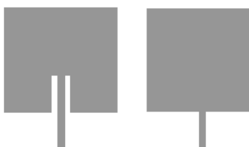
Obrázek 19 Napájení pomocí mikropáskového vedení
