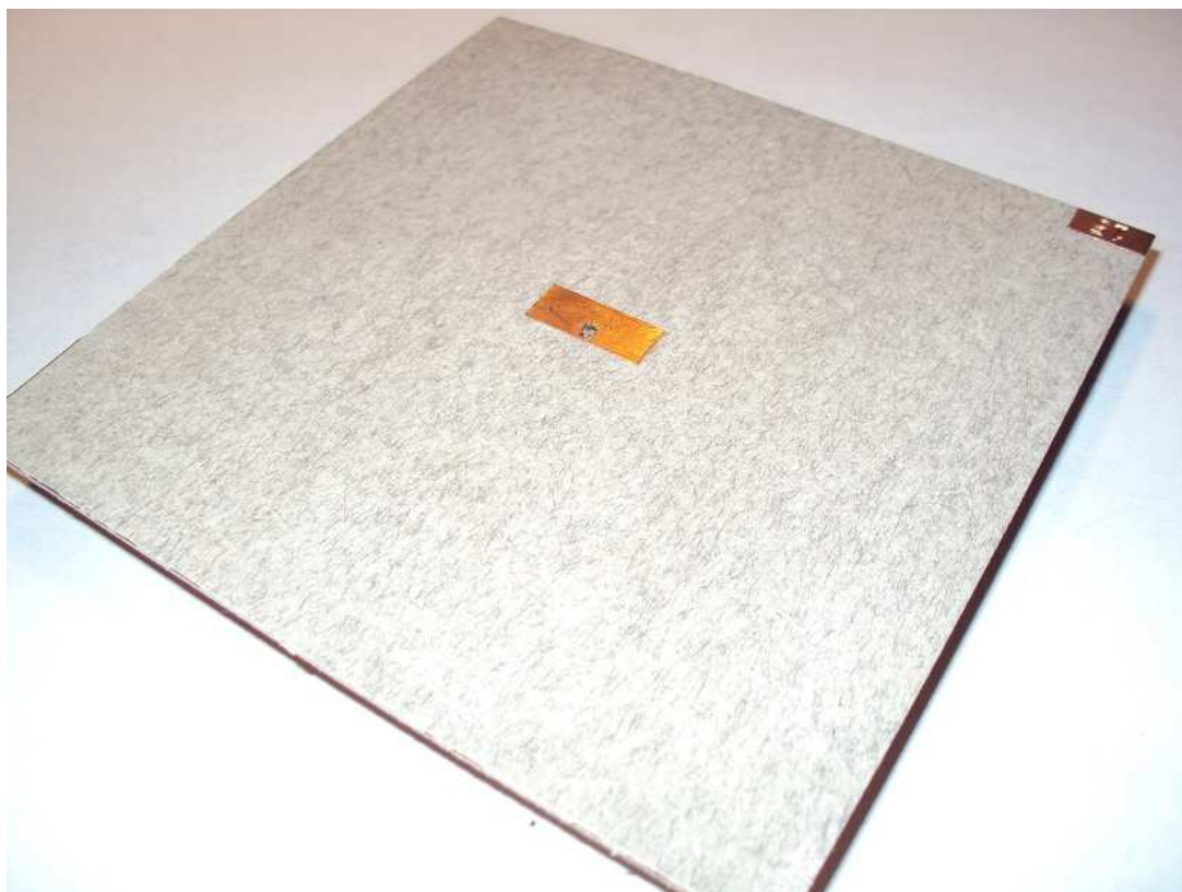
Příloha 8 Zkonstruovaná mikropásková anténa - čelní pohled
