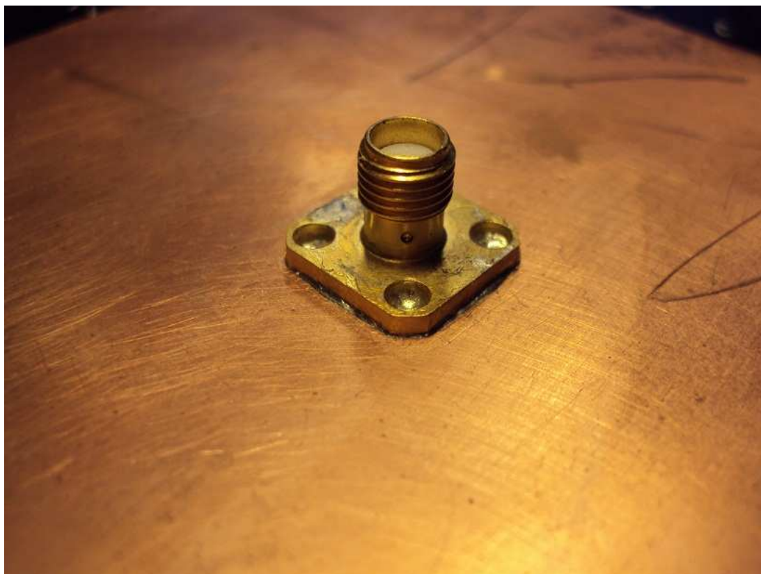
Příloha 9 Zkonstruovaná mikropásková anténa – zadní pohled
