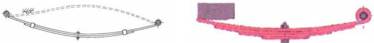
Obr. 8 Porovnání řešení progresivity stupňovitou změnou činné délky listového pera a plynulou změnou činné délky listového pera [1],
