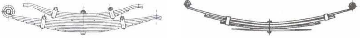
Obr.7 Porovnání řešení progresivity pomocí přídavného listového pera (stupňovitě) a přídavného listu s plynulou změnou činné délky (kombinovaná progresivita) [1]
