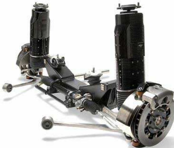
Obr. 34 Pérování pomocí lineárních elektromotorů [10]
