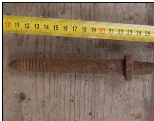
Petroupim čp. 23 – detail šroubu vyjmutého ze stojky portálu
