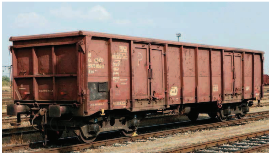
Obr. 6 Čtyřnápravový vysokostěnný vůz
