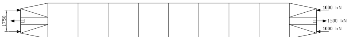
Obr. 16 Schéma statické zkoušky stlačovací a tahové na spodek vozidla
