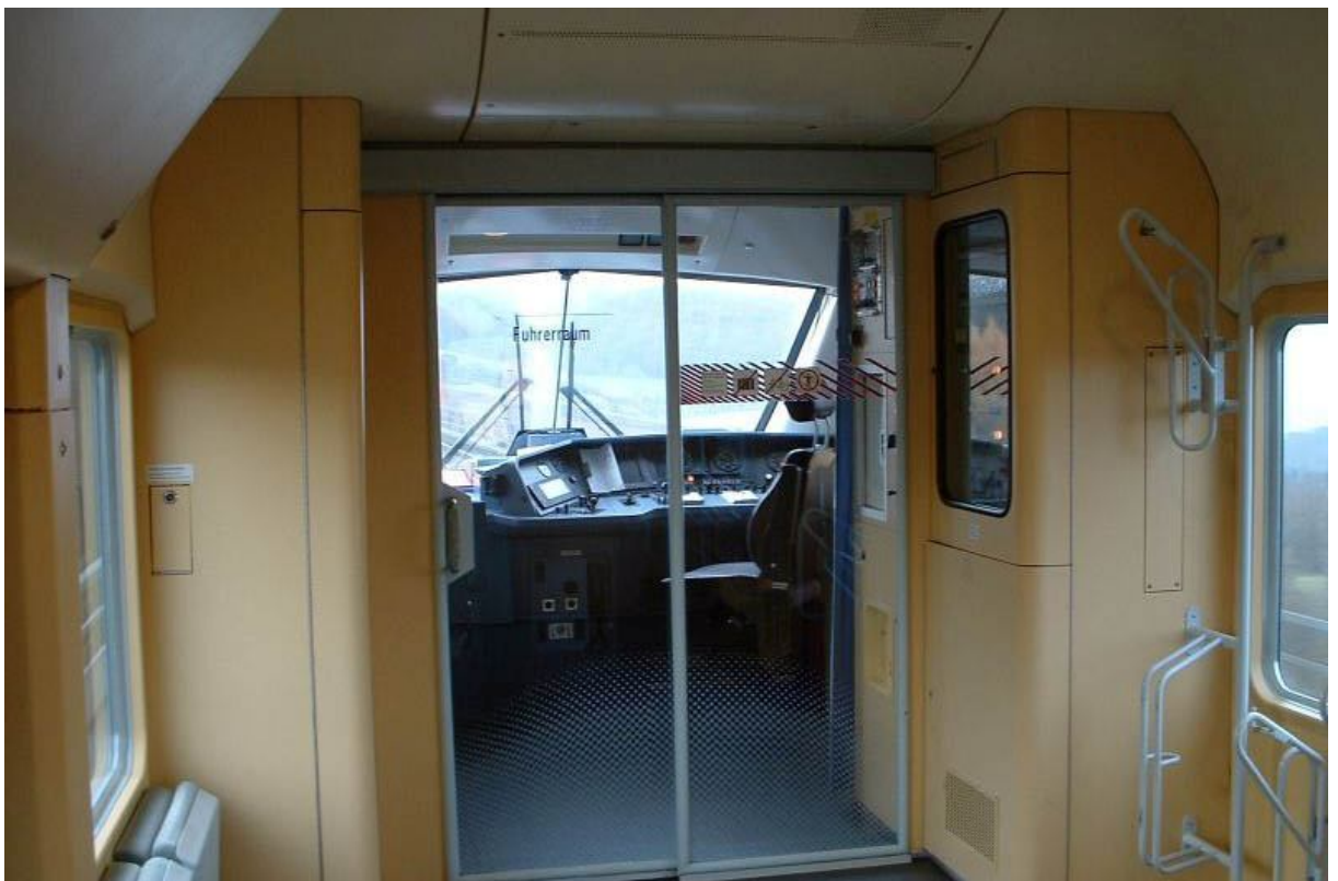
Obr. 11 Oddíl pro jízdní kola a pohled do kabiny strojvedoucího vozu D-DB Bpmbdzf [7]
