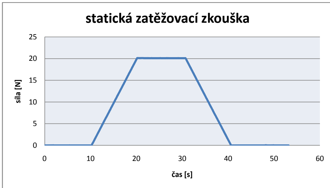
Graf 1 Statická zatěžovací zkouška – zatížení stavem INOVA
