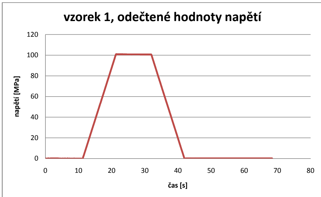
Graf 2 VZOREK 1, statická zkouška, odečtené hodnoty napětí DMC HBM
