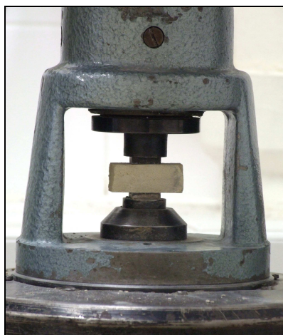
Obr. 3.14: Přístroj pro měření pevnosti v tlaku, detail lisovací hlavy.
