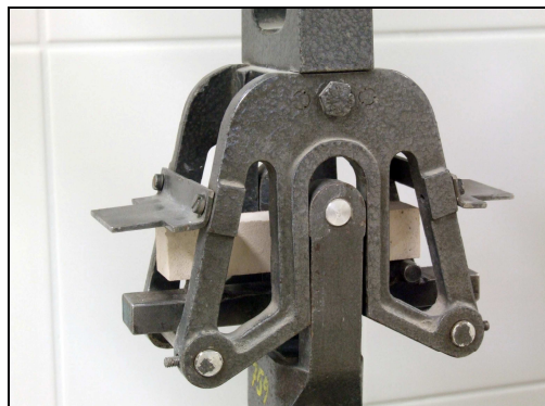
Obr. 3.13: Přístroj pro stanovení pevnosti v tahu za ohybu, detail.
